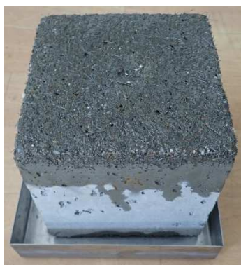
Obrázok 34 - vzorka po skúške CHRL. [autor]
