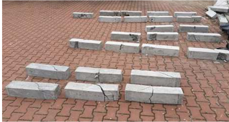
Obrázok 30 - Vzorky po skúške pevnosti v ťahu za ohybu. [autor]
