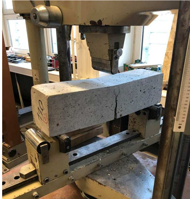
Obrázok 29 - Skúška trámca na pevnosť v ťahu za ohybu s drôtikmi MasterFiber 482. [3]
