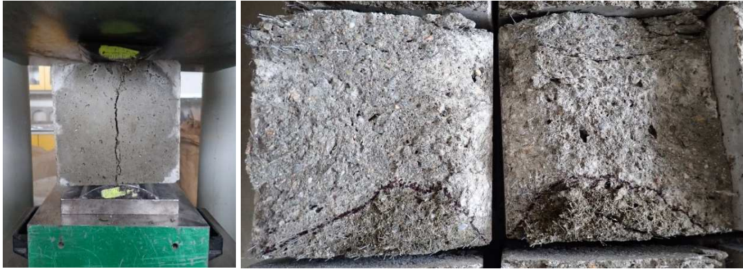
Obrázok 32 - Skúška priepustnosti drátkobetónu s drôtikmi MasterFiber 482 s dávkovaním 110 kg/m 3 . [autor]
