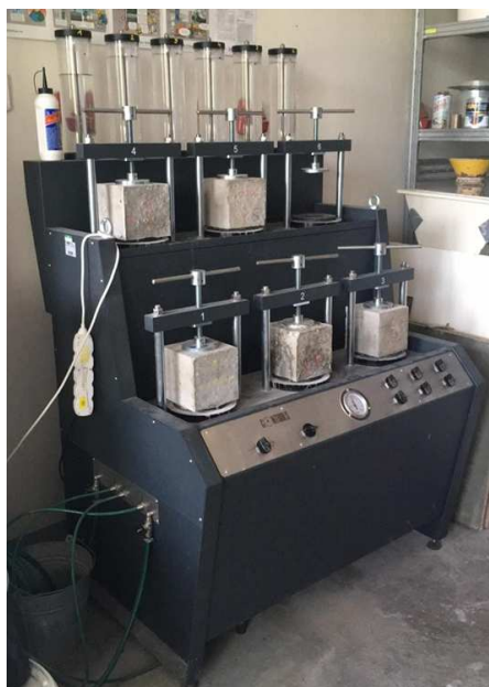
Obrázok 13 - Meranie hĺbky priesaku tlakovou vodou [autor]
