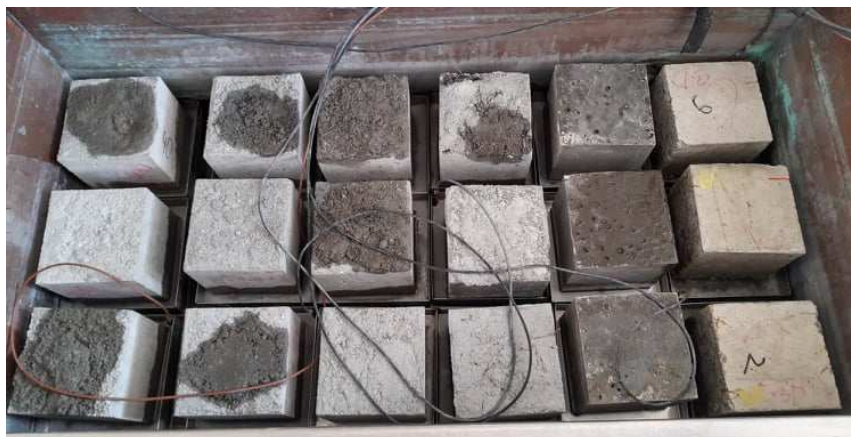
Obrázok 14 - Uloženie vzoriek na skúšku CHRL [autor]
