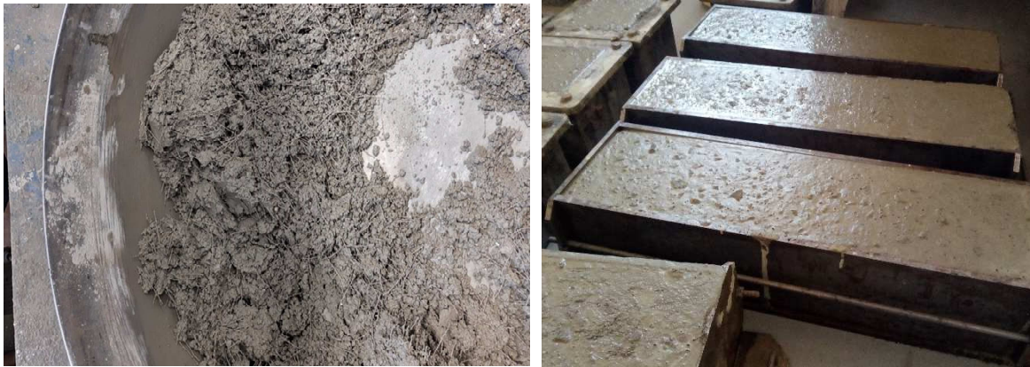
Obrázok 2 - Výroba a ukladanie drátkobetónu. [autor]
