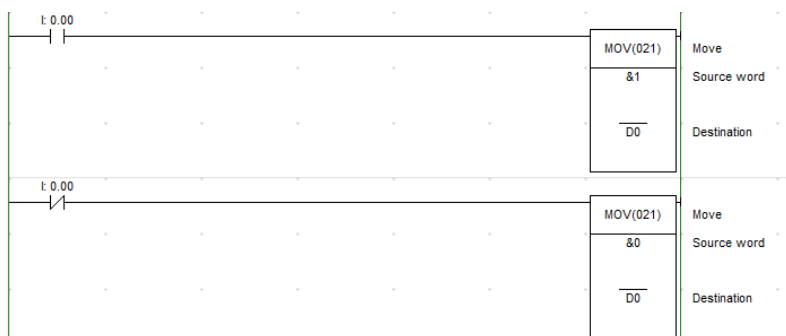
Figur 2.60: Sending av 1 og 0 til D minnet i CP1L
