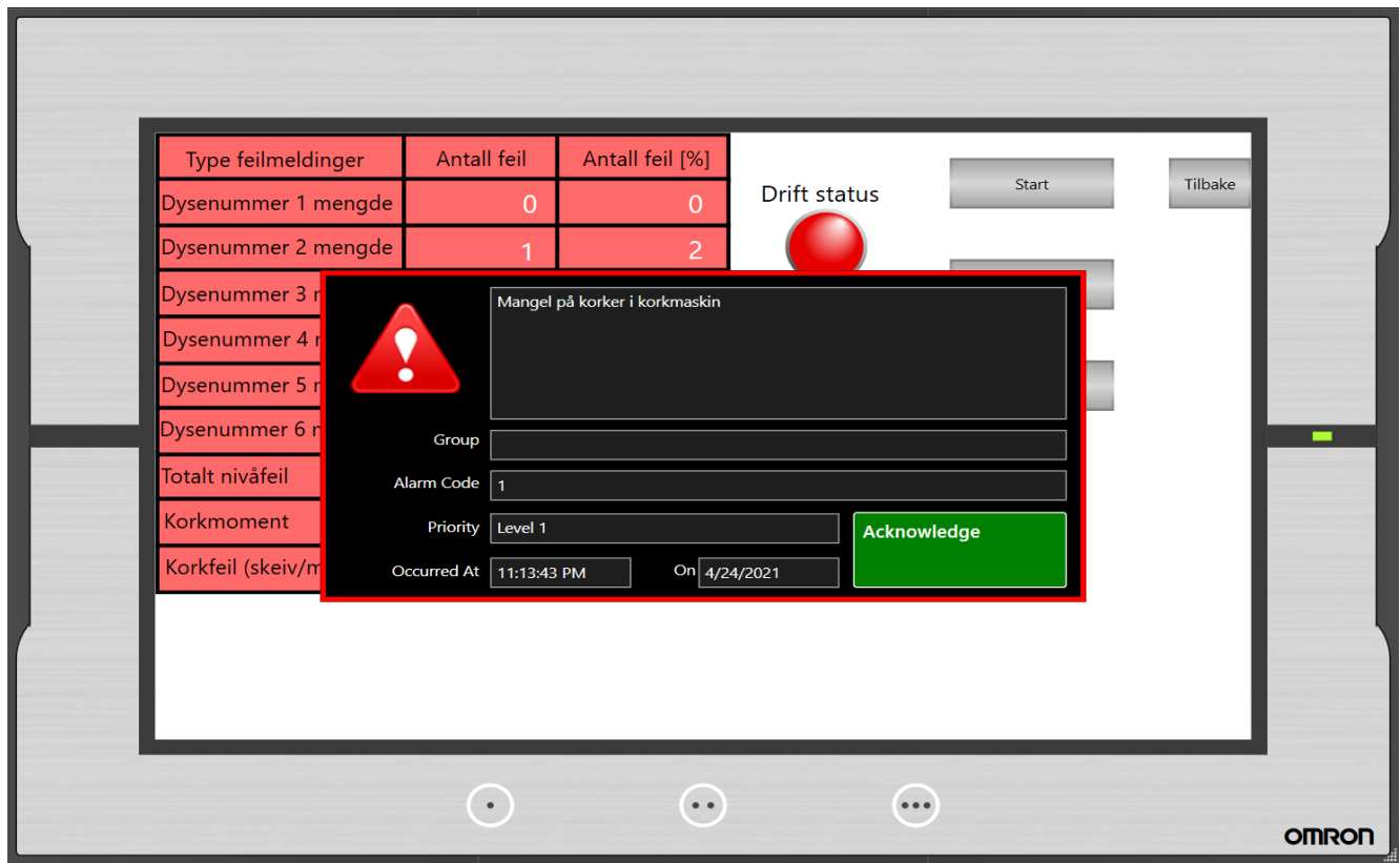
Figur 2.76: Eksempel på alarm notifikasjon under drift, feilmeldingen forsvinner hvis man trykker på "Acknowledge". Det vil bli vist i alarmhistorikken på HMI-skjermen 2.75 etter man har trykket på "Acknowledge"
