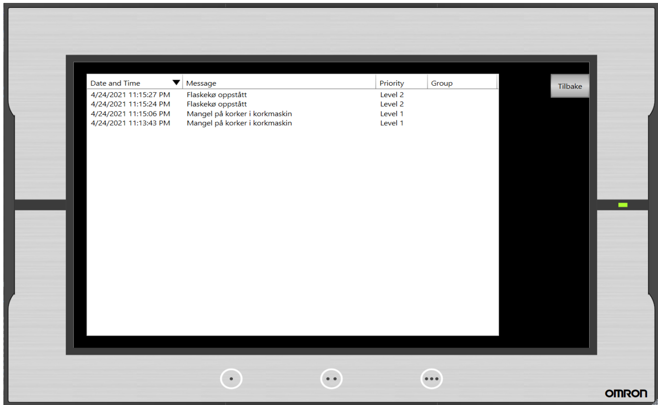
Figur 2.75: Denne HMI-skjermen inneholder en liste over alle alarmer. Det er tre typer feilmeldinger som blir definert som "Alarmer", "Korkmaskin_tom" som indikerer mangel på korker i korkreservoar, denne har prioritetsnivå 1 som der av høyeste nivå. Alarm nummer 2 er "Flaskekø", denne beskriver at det har oppstått kø, noe som indikerer at mating av flasker bør stoppes. Denne alarmeren har prioritetsnivå 3, dette er ikke en alarm som behøver umiddelbar oppmerksomhet. Alarm nummer 3 er "Væskebeholder lavt nivå", denne alarmeren har prioritetsnivå 1 siden mangel på væske krever umiddelbar oppmerksomhet for å forhindre feilproduksjon.
