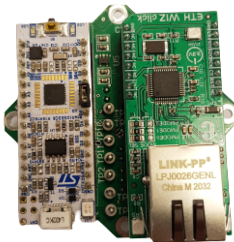
(c) Bilde av topplaget til det ferdig produserte kretskortet med mikrokontroller og Ethernet modul.
