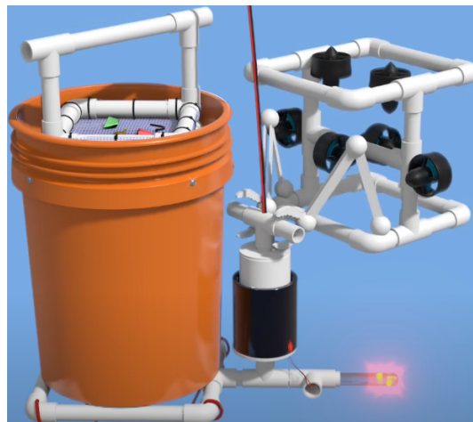
Figur 8: Ved at ROV-en fjerner støpselet fra søppelbøtta vil lyset slukkes. Videre i oppgaven fjerner man fangstposen med objekter i, for å så returnere med en ny fangstpose. Hentet fra [42]
