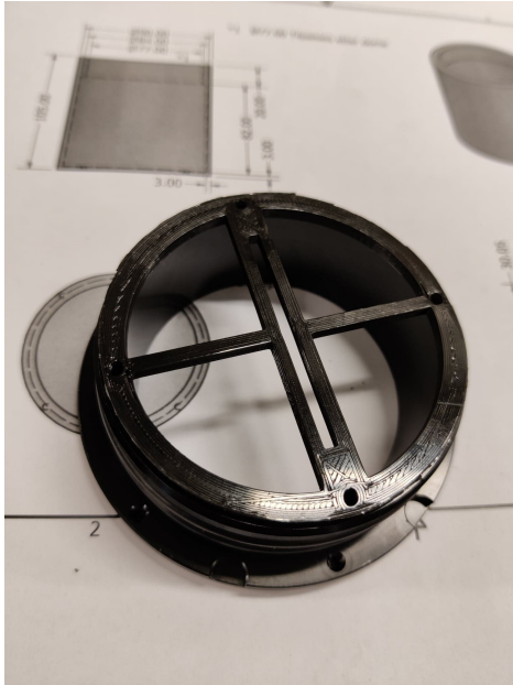
(a) Kameraringen satt på innsiden av flensen. Ikke satt inn skruer enda.
