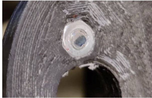
(b) Påmontert med bunnslipt bolt.
