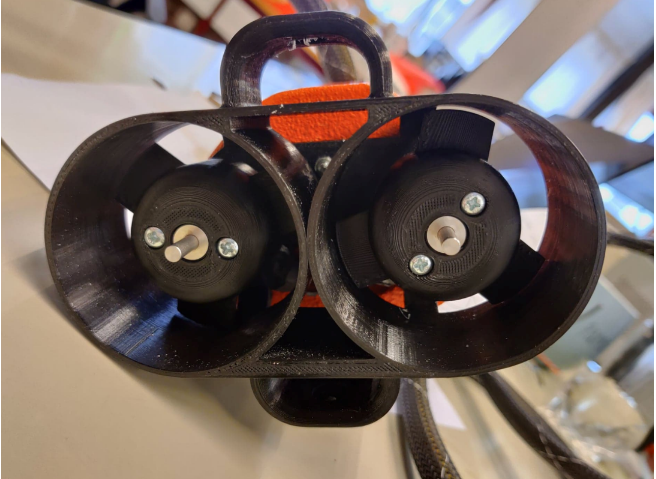
Figur 151: Motordel med begge de horisontale motorene ferdig montert.
