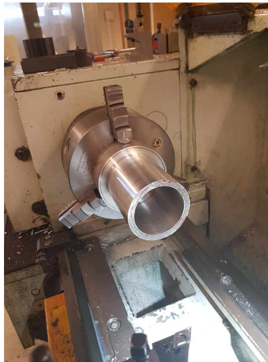
(c) Foto av elektronikkhuset ferdig dreiet utvendig.
