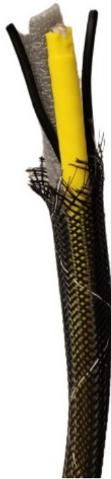
Figur 136: Foto av navlestrengen som brukes til Mikro-ROVen. Gul kabel er signalkabel, svarte ledninger er kraftforsyning og den grå er flyteelement.
