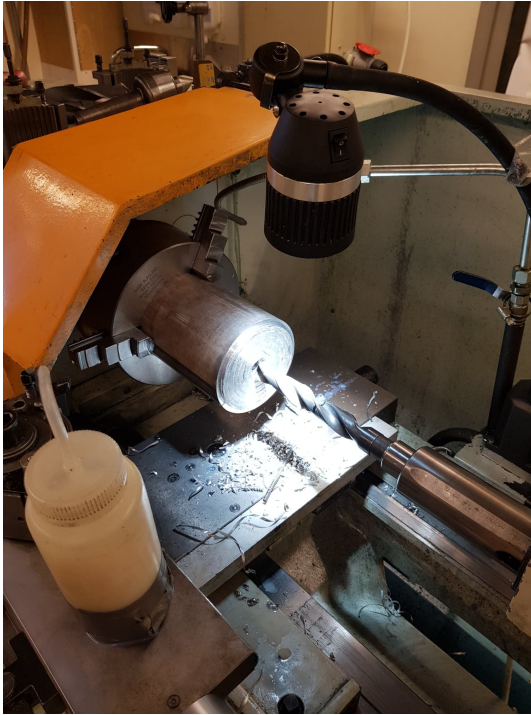
(a) Foto av aluminiumstykket før bearbeiding til å bli et elektronikkhus.
