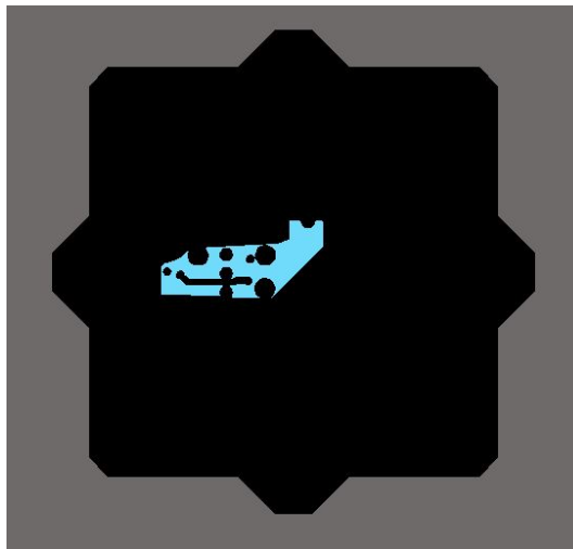
Figur 82: Det blå feltet er polygonet som skjermer den analoge banen i 12+ laget. Polygonet er kun koblet til GND i ett punkt for å unngå at de går jordstrømmer gjennom polygonet.
