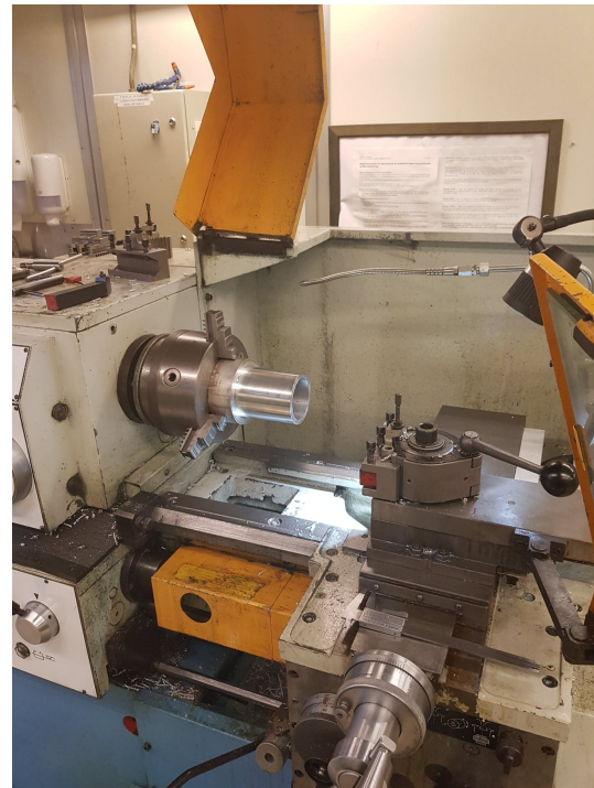
(b) Foto av elektronikkhuset på dreiebenken.
