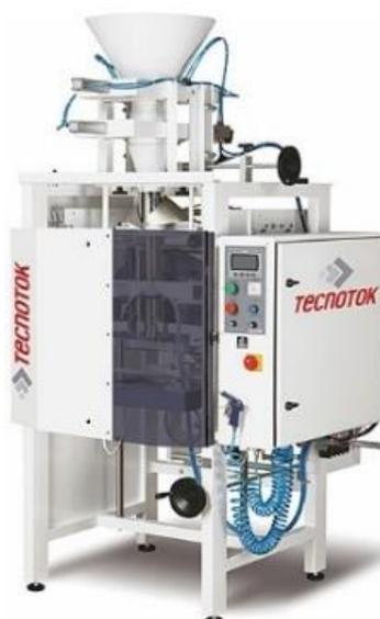
Figura 31: Imagen referencia de Embolsadora Vertical.
