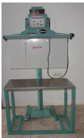
Figura 12: Equipos y maquinaria de la empresa - Sellador de pedal por barra caliente
