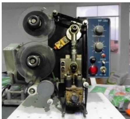
Figura 10: Equipos y maquinaria de la empresa - Codificador Hot Stamping
