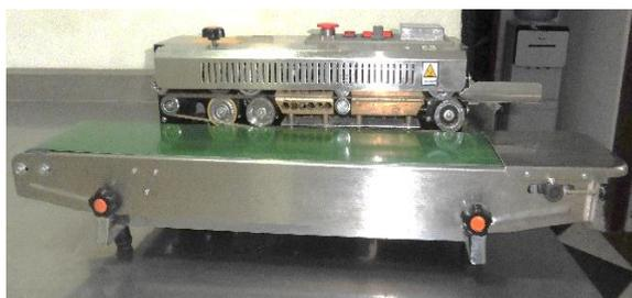
Figura 9: Equipos y maquinarias de la empresa - Selladora continua horizontal
