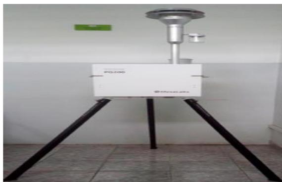
**Nota:** Fotografía del Muestreador De Partículas Low-Vol, Modelo PQ200 FRM de BGI
