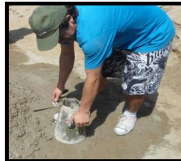
Ensayo de consistencia
