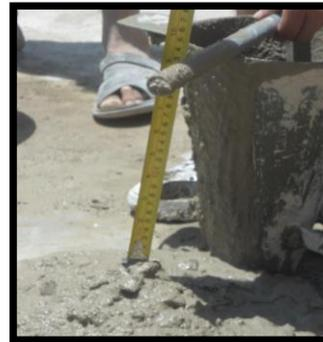
Ensayo de consistencia
