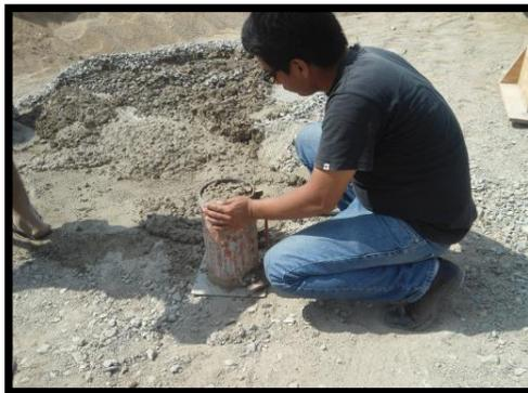
Elaboración de Probetas de Concreto
