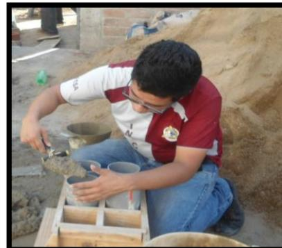
Elaboración de Probetas de Concreto
