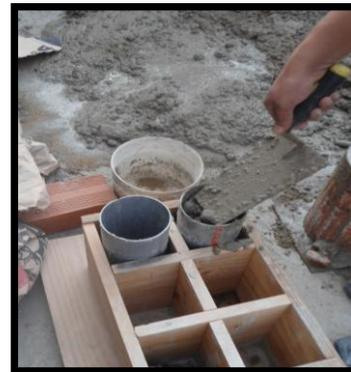
Elaboración de Probetas de Concreto
