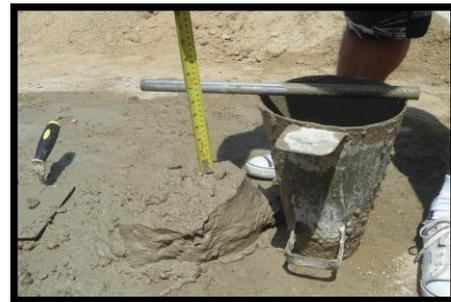
Ensayo de consistencia
