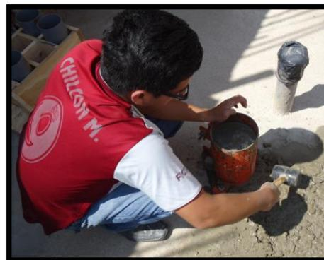
Elaboración de Probetas de Concreto
