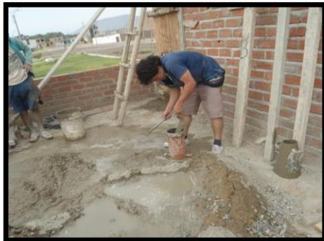
Elaboración de Probetas de Concreto (15 x 30 cm)
