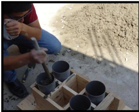
Elaboración de Probetas de Concreto
