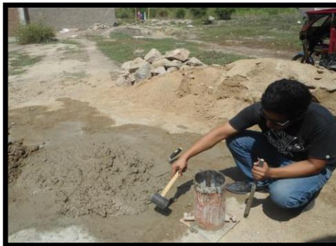
Elaboración de Probetas de Concreto
