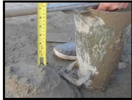
Ensayo de consistencia
