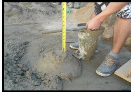
Ensayo de consistencia
