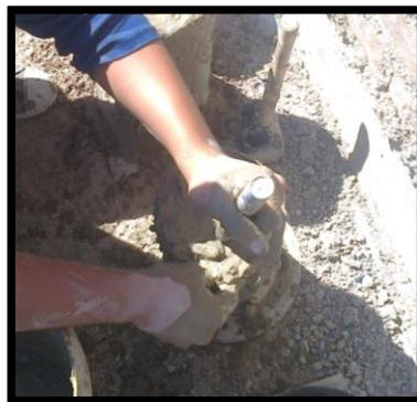
Elaboración de Probetas de Concreto
