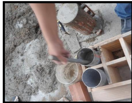
Elaboración de Probetas de Concreto
