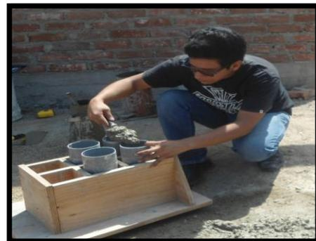
Elaboración de Probetas de Concreto
