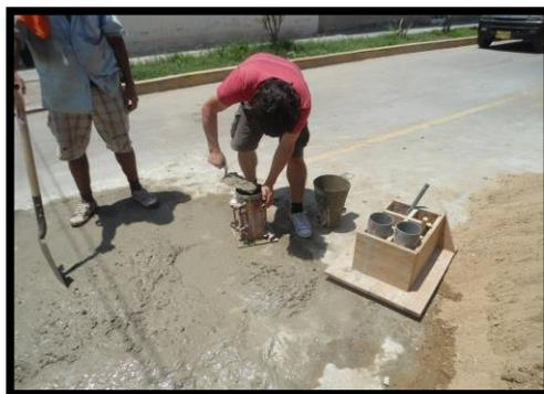
Elaboración de Probetas de Concreto
