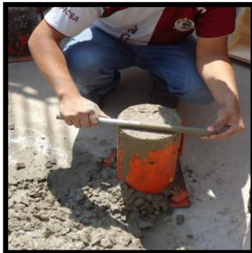
Elaboración de Probetas de Concreto
