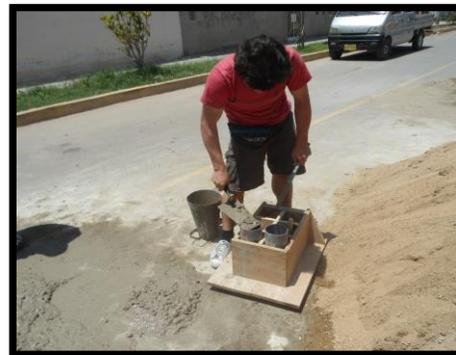
Elaboración de Probetas de Concreto
