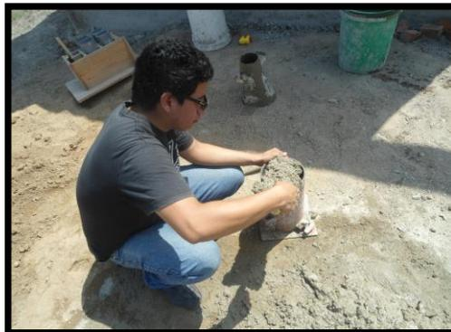
Elaboración de Probetas de Concreto
