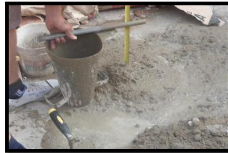
Ensayo de consistencia
