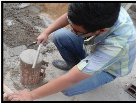
Elaboración de Probetas de Concreto
