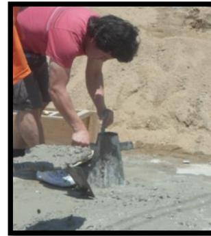
Ensayo de consistencia
