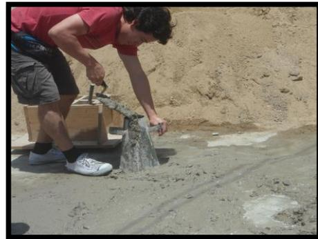
Ensayo de consistencia
