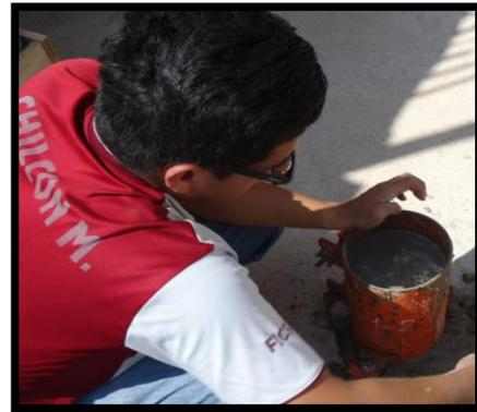
Elaboración de Probetas de Concreto
