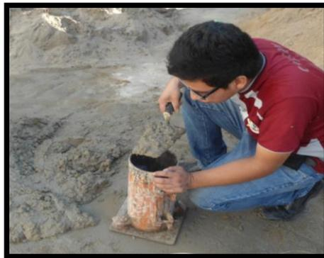
Elaboración de Probetas de Concreto
