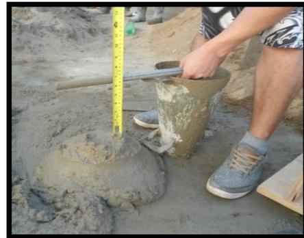
Ensayo de consistencia
