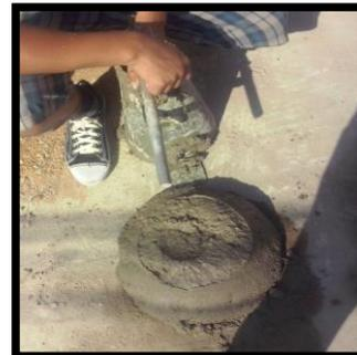
Ensayo de consistencia
