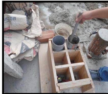
Elaboración de Probetas de Concreto
