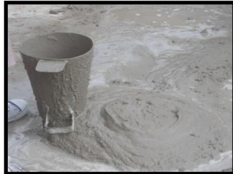
Ensayo de consistencia
