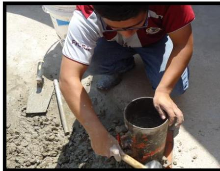
Elaboración de Probetas de Concreto
