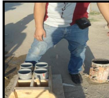
Elaboración de Probetas de Concreto
