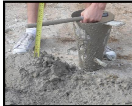
Ensayo de consistencia
