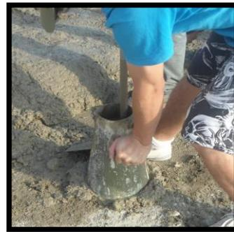
Ensayo de consistencia
