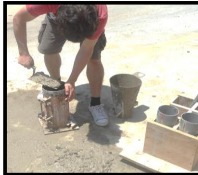
Elaboración de Probetas de Concreto
