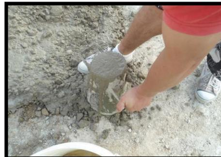
Ensayo de consistencia
