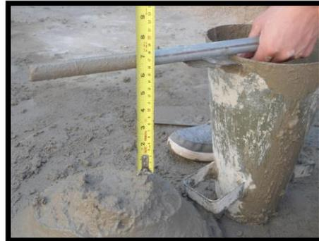
Ensayo de consistencia
