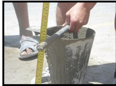
Ensayo de consistencia
