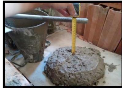
Ensayo de consistencia
