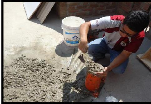
Elaboración de Probetas de Concreto
