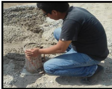
Elaboración de Probetas de Concreto
