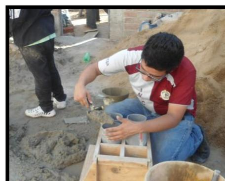
Elaboración de Probetas de Concreto
