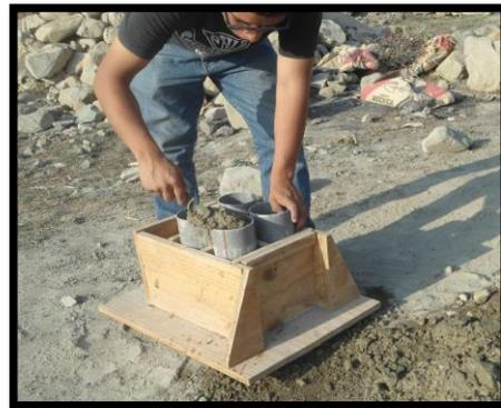
Elaboración de Probetas de Concreto
