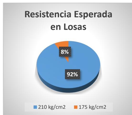
Las dosificaciones utilizadas por los maestros de obra son altas y en muchos de los casos se agrega más agua a la mezcla para darle mayor trabajabilidad lo cual disminuye la resistencia a compresión del elemento estructural, también se realizó el ensayo de revenimiento en obra obteniéndose asentamientos elevados. Estos factores indican que los concretos elaborados en obra no alcanzaran la calidad requerida.
