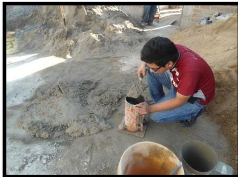
Elaboración de Probetas de Concreto
