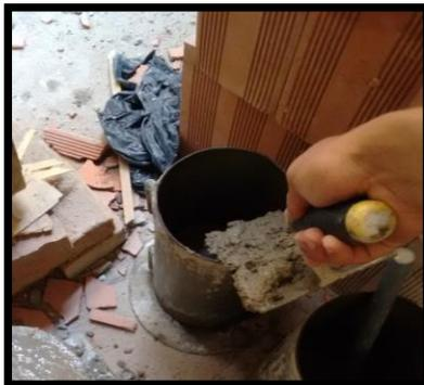
Elaboración de Probetas de Concreto
