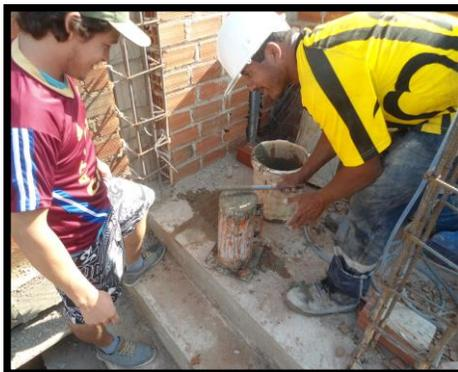
Elaboración de Probetas de Concreto
