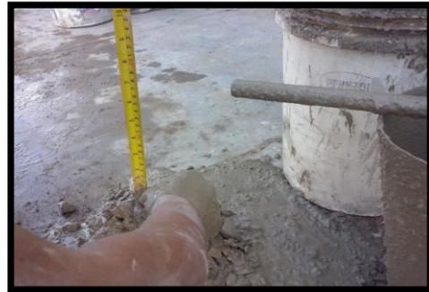
Ensayo de consistencia
