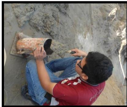
Elaboración de Probetas de Concreto
