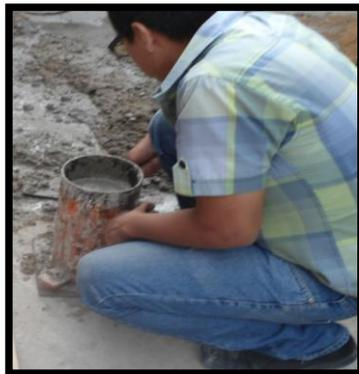
Elaboración de Probetas de Concreto
