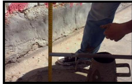
Ensayo de consistencia
