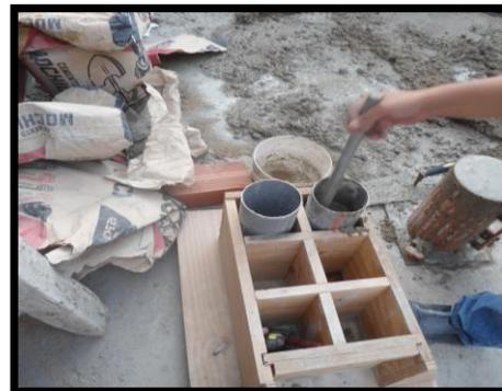
Elaboración de Probetas de Concreto
