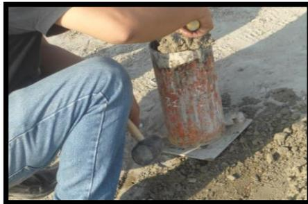
Elaboración de Probetas de Concreto
