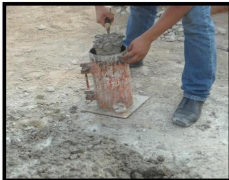
Elaboración de Probetas de Concreto
