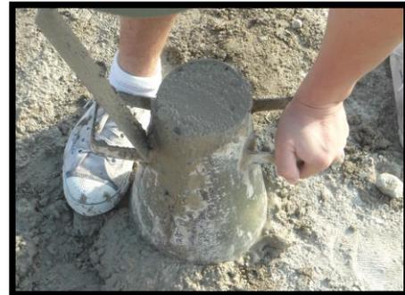
Ensayo de consistencia
