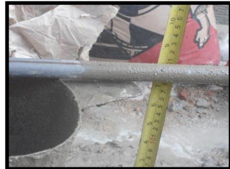
Ensayo de consistencia
