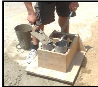
Elaboración de Probetas de Concreto
