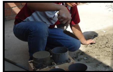
Elaboración de Probetas de Concreto
