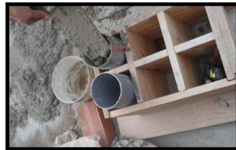
Elaboración de Probetas de Concreto
