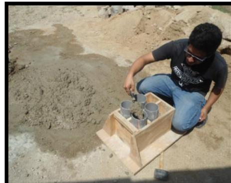
Elaboración de Probetas de Concreto
