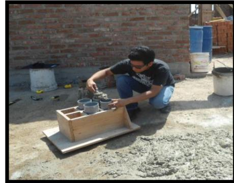
Elaboración de Probetas de Concreto
