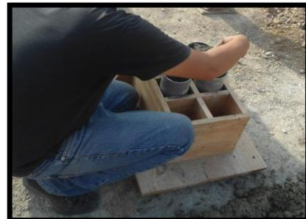
Elaboración de Probetas de Concreto
