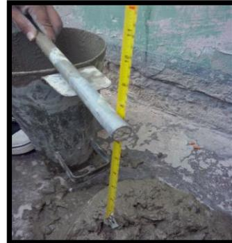
Ensayo de consistencia
