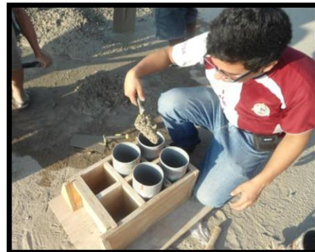
Elaboración de Probetas de Concreto
