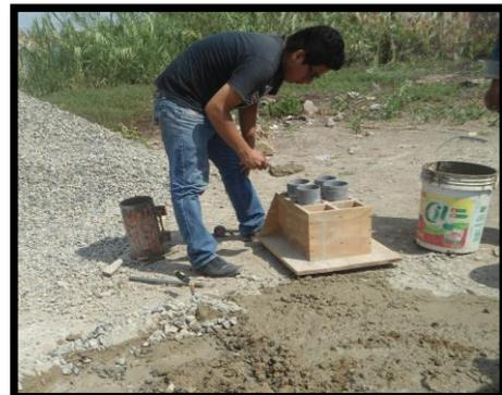
Elaboración de Probetas de Concreto
