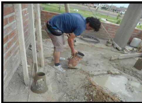
Elaboración de Probetas de Concreto
