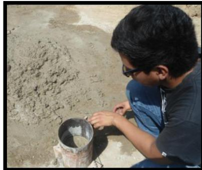
Elaboración de Probetas de Concreto
