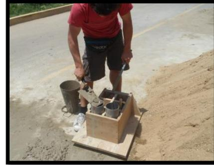
Elaboración de Probetas de Concreto
