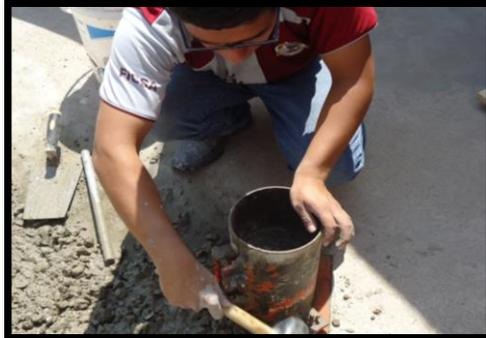
Elaboración de Probetas de Concreto
