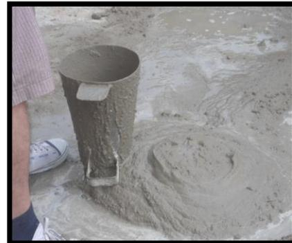
Ensayo de consistencia
