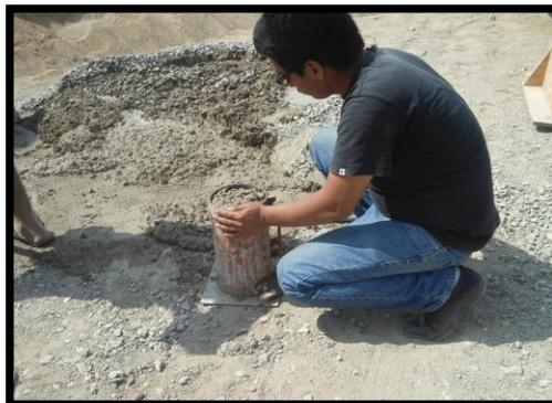
Elaboración de Probetas de Concreto
