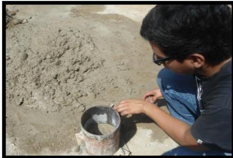
Elaboración de Probetas de Concreto
