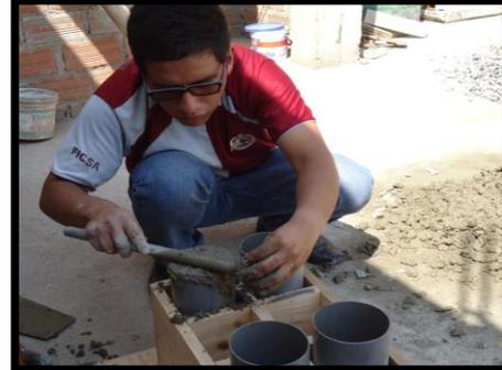
Elaboración de Probetas de Concreto
