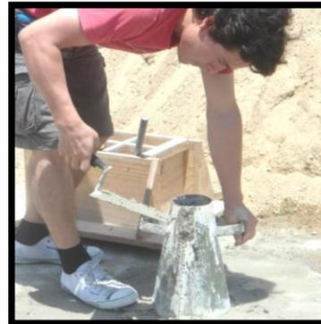
Ensayo de consistencia
