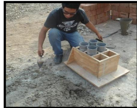
Elaboración de Probetas de Concreto
