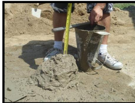
Ensayo de consistencia
