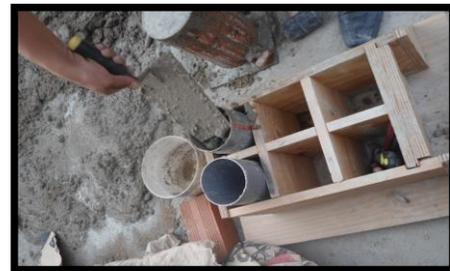
Elaboración de Probetas de Concreto
