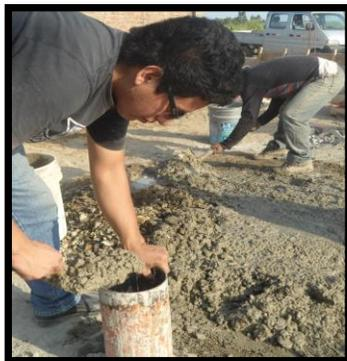
Elaboración de Probetas de Concreto
