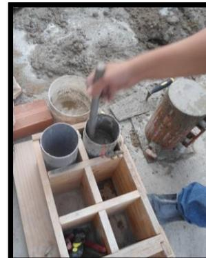
Elaboración de Probetas de Concreto
