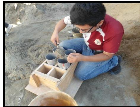
Elaboración de Probetas de Concreto
