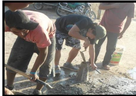
Ensayo de consistencia
