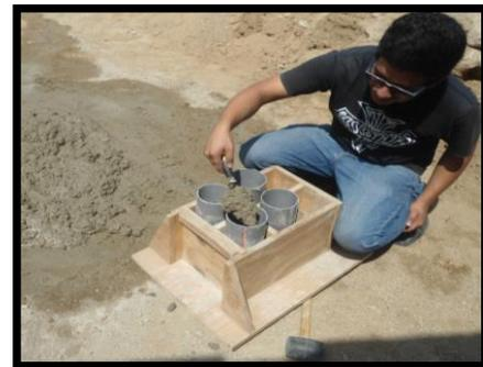
Elaboración de Probetas de Concreto
