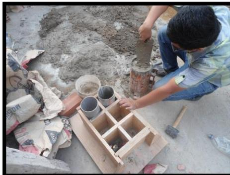
Elaboración de Probetas de Concreto
