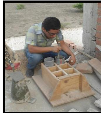
Elaboración de Probetas de Concreto
