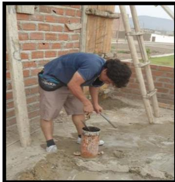
Elaboración de Probetas de Concreto
