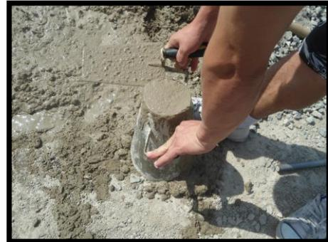
Ensayo de consistencia
