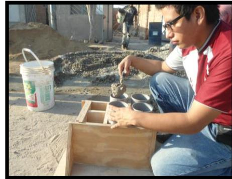
Elaboración de Probetas de Concreto
