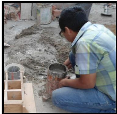
Elaboración de Probetas de Concreto
