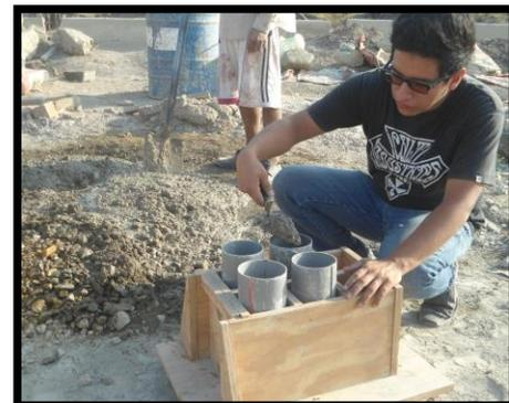
Elaboración de Probetas de Concreto
