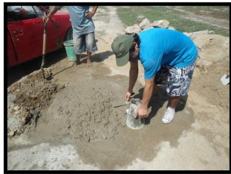
Ensayo de consistencia
