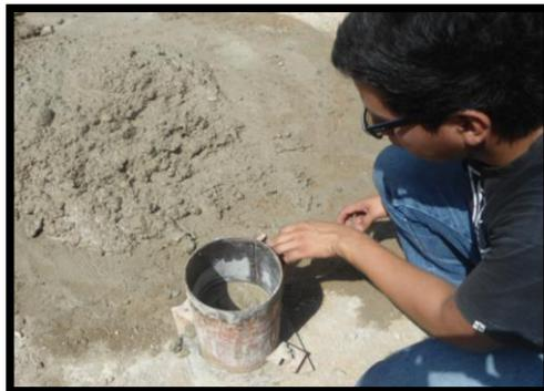
Elaboración de Probetas de Concreto
