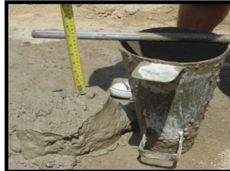
Ensayo de consistencia
