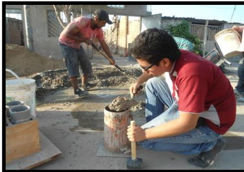
Elaboración de Probetas de Concreto
