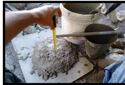
Ensayo de consistencia
