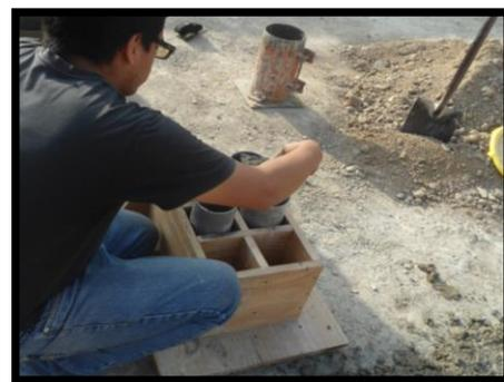
Elaboración de Probetas de Concreto
