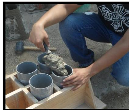
Elaboración de Probetas de Concreto
