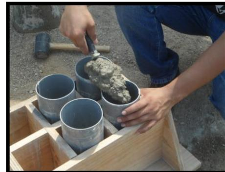
Elaboración de Probetas de Concreto
