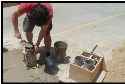
Elaboración de Probetas de Concreto
