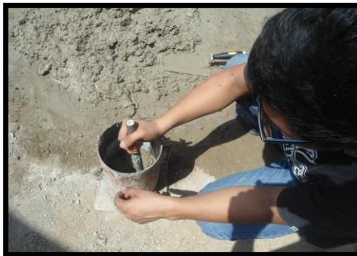
Elaboración de Probetas de Concreto
