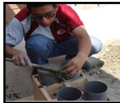
Elaboración de Probetas de Concreto
