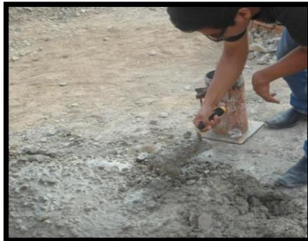
Elaboración de Probetas de Concreto
