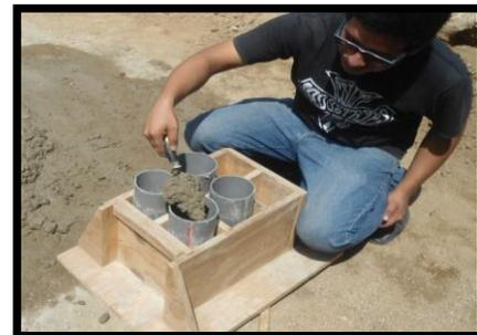
Elaboración de Probetas de Concreto
