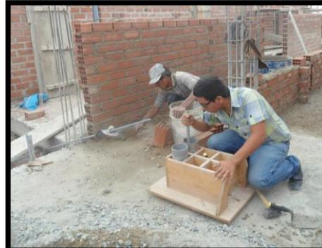
Elaboración de Probetas de Concreto (10 x 30cm)
