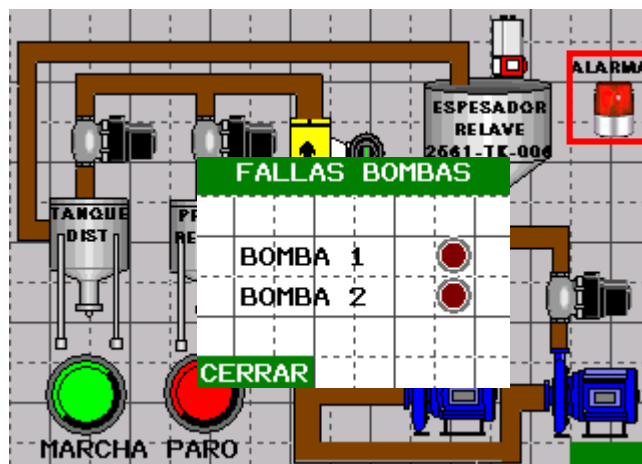
Pantalla Emergente de Falla de Bombas
