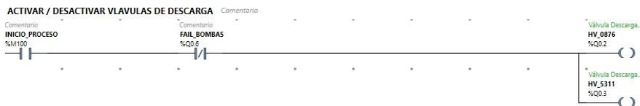
Programación Ladder - Activar / Desactivar Válvulas de Descarga
