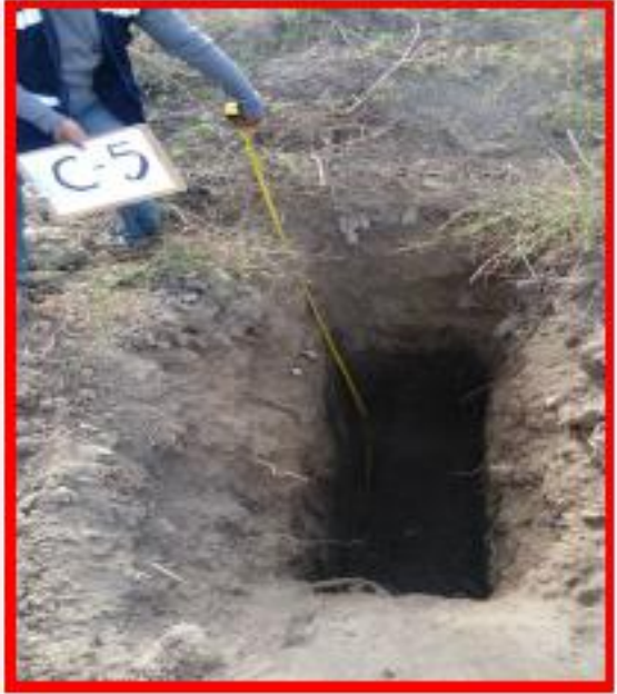
Foto N° 10. Detalle del perfil del suelo en Calicata C-5.
