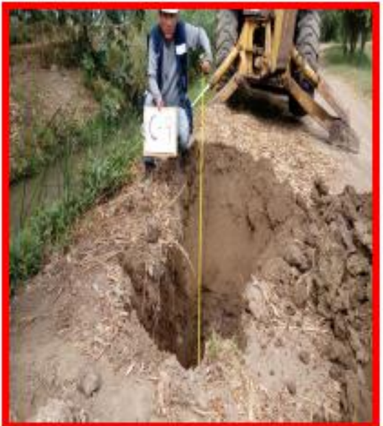
Foto N° 20. Detalle del perfil del suelo en Calicata C-9.
