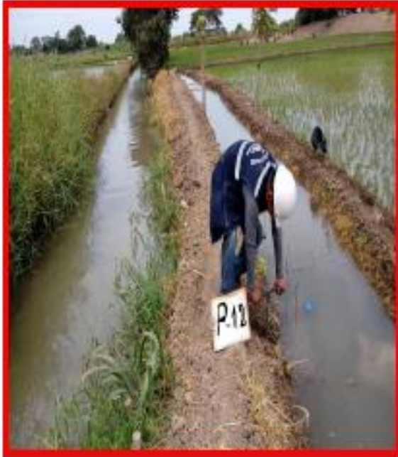
Foto N° 25. Ubicación y realización del Muestreo con posteadora del suelo P-12 a -2.00 m.
