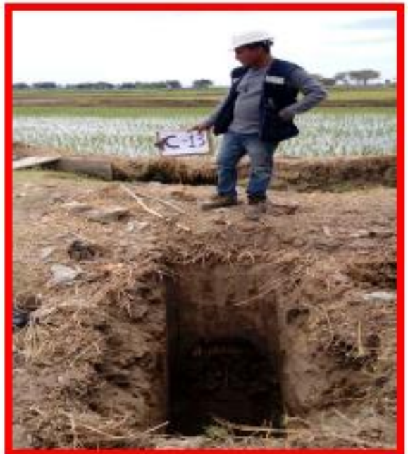
Foto N° 28. Detalle del perfil del suelo en Calicata C-13.
