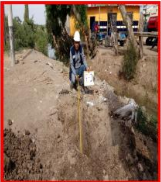
Foto N° 16. Detalle del perfil del suelo en Calicata C-7.
