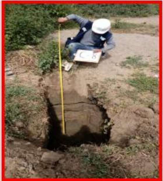
Foto N° 18. Detalle del perfil del suelo en Calicata C-8.
