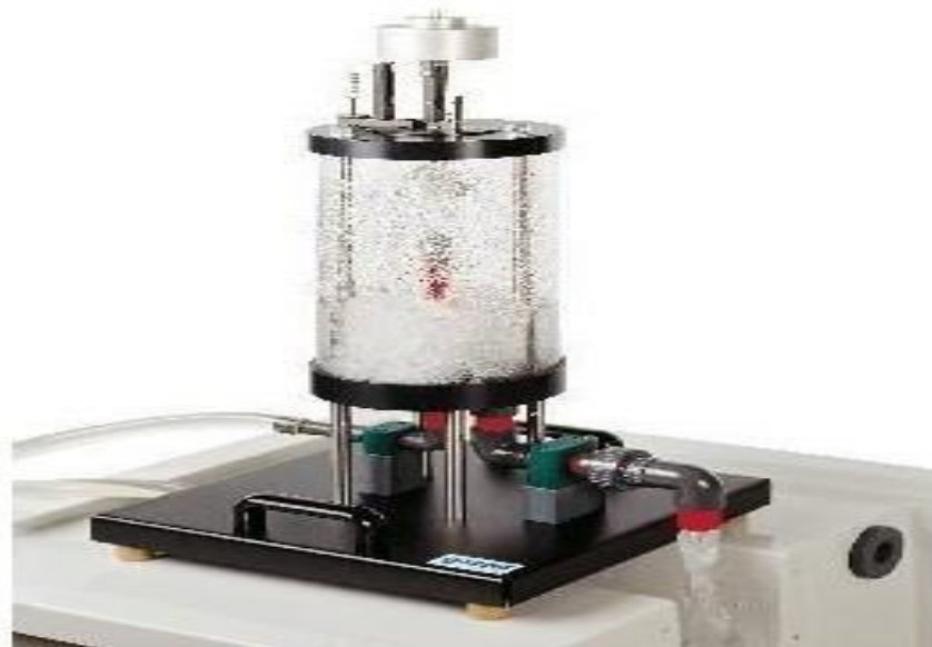
Figura 7. Medición de Fuerza ejercida por un Chorro
