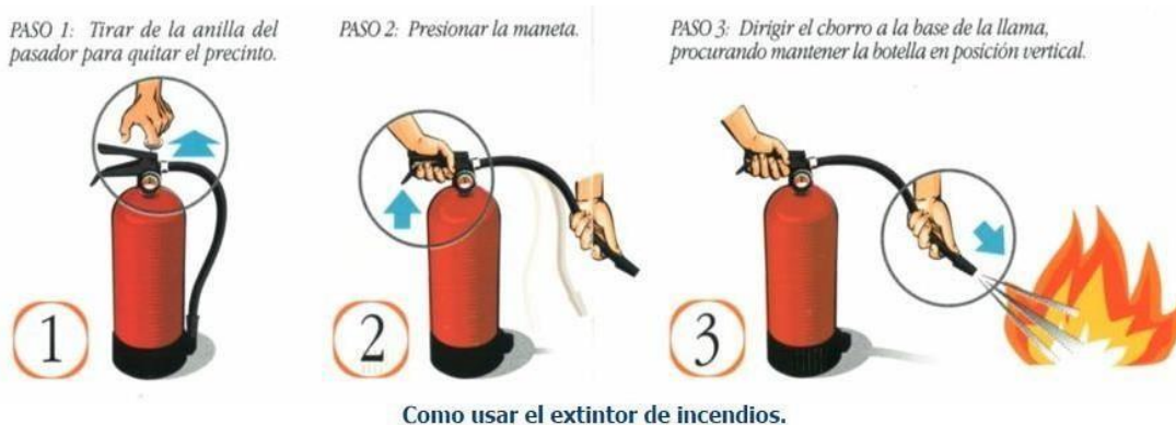
Figura 57. Como usar el extintor de incendios
