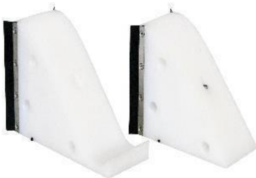
Figura 32. Presa Vertedero de Perfil OGEE con dos tipos de salida Fuente: Npz Science Technology E.I.R.L
