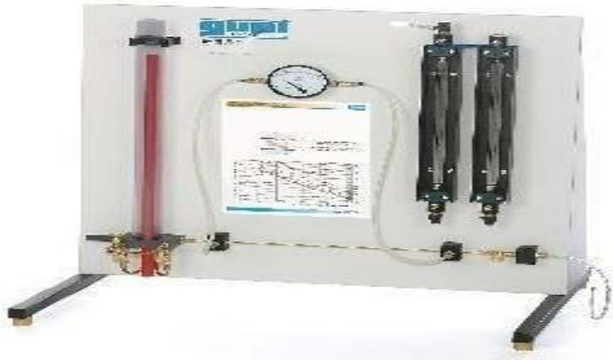
Figura 13. Fricción de Tubo en Flujo Laminar/Turbulento.
