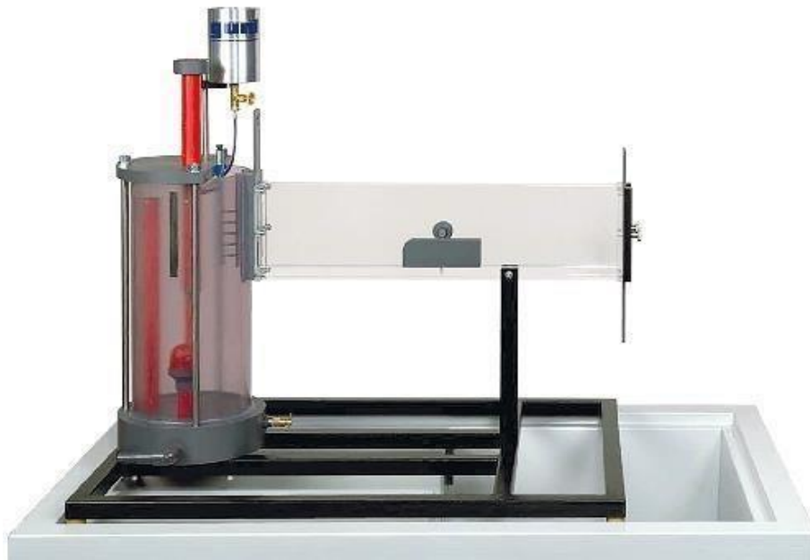
Figura 15. Visualización de líneas de Corriente en Canales Abiertos.
