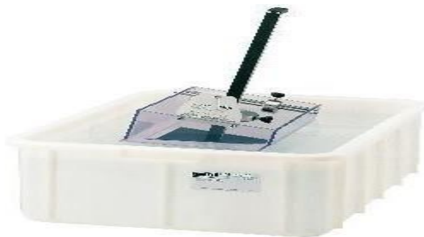
Figura 17. Estabilidad de Cuerpos Flotantes.
