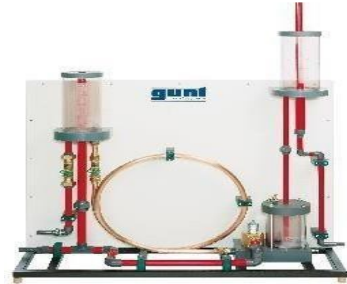
Figura 21. Ariete Hidráulico- Elevación con ayuda de Golpes de Ariete
