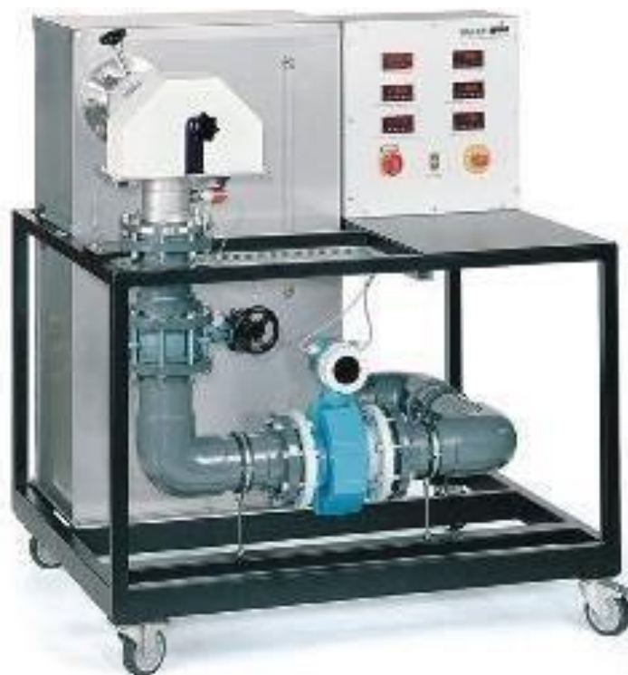
Figura 49. Banco de Ensayos Turbina de Kaplan. Fuente: Npz Science Technology E.I.R.L
