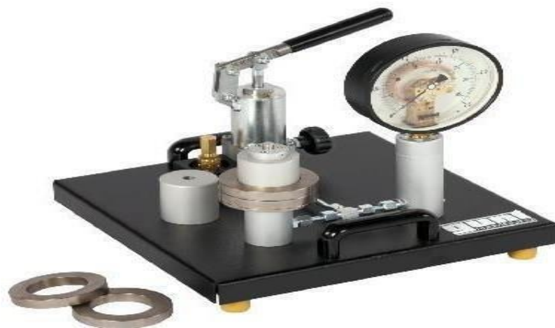
Figura 16. Calibración de Instrumentos de Medición de Presión.
