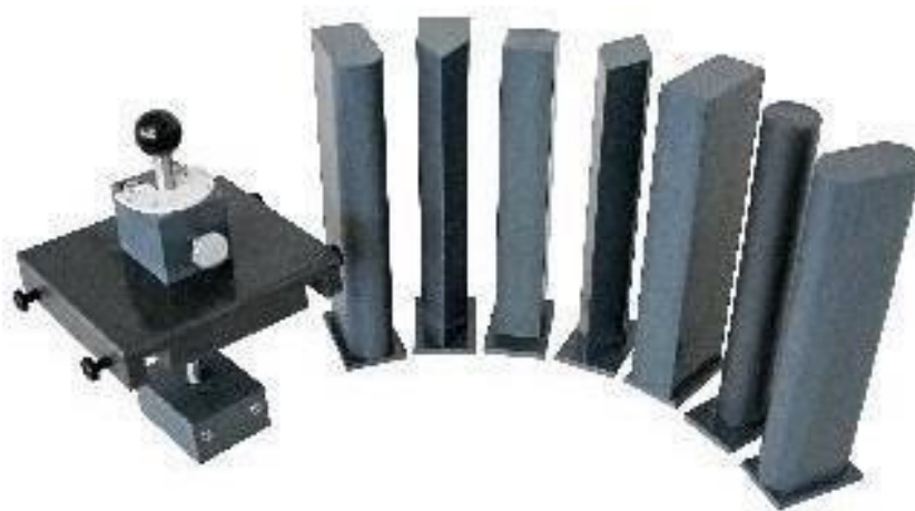
Figura 37. Juego de Pilares Siete Perfiles
