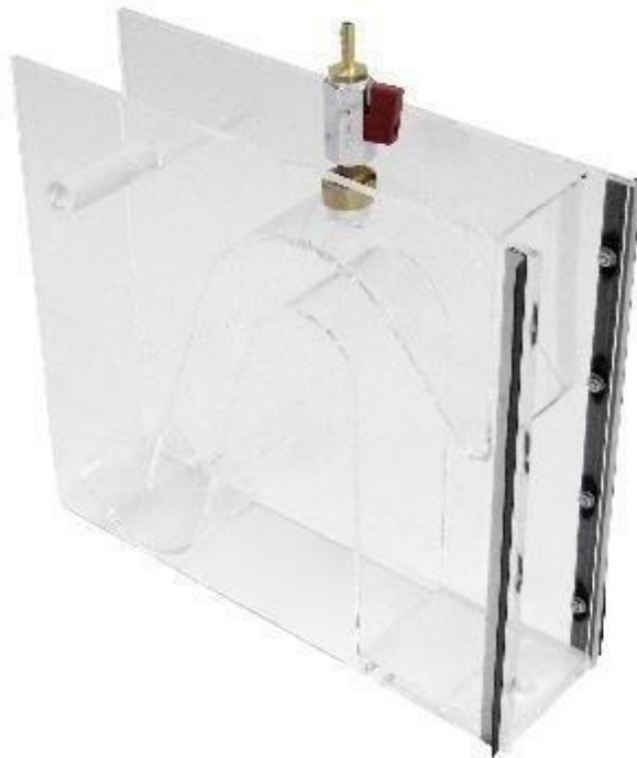
Figura 30. Vertedero SIFON Fuente: Npz Science Technology E.I.R.L
