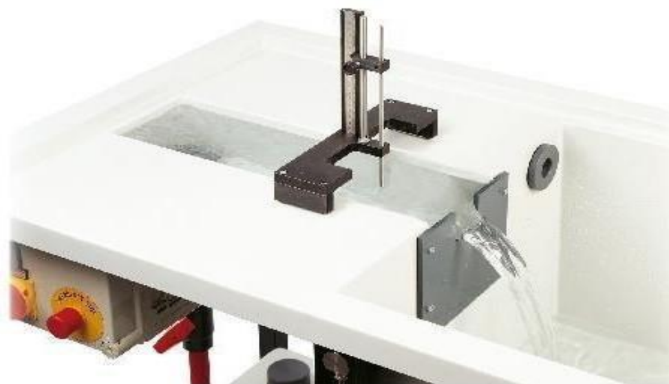
Figura 8. Vertederos de Cresta Delgada para Módulo Básico de Ensayos sobre Mecánica de Fluidos
