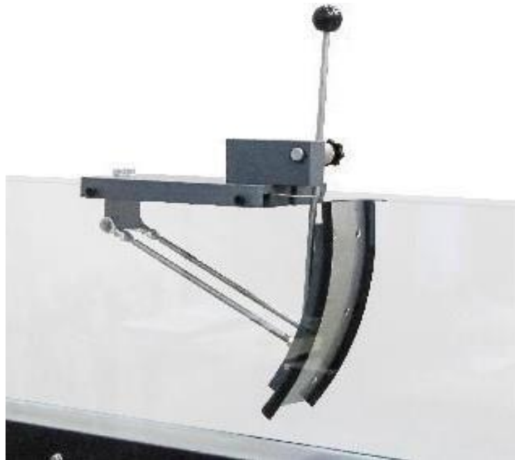
Figura 26. Compuerta de Segmento Fuente: Npz Science Technology E.I.R.L
