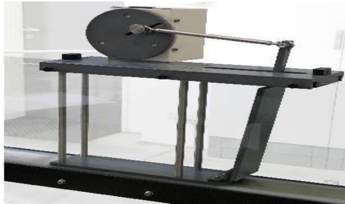
Figura 42. Generador de Olas Fuente: Npz Science Technology E.I.R.L
