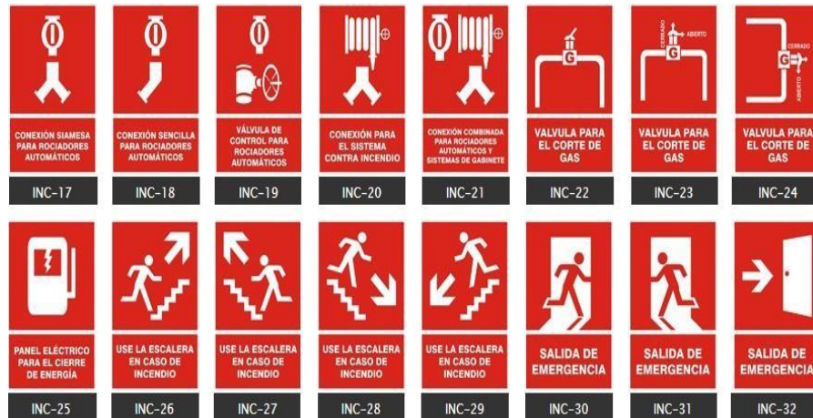
Figura 53. Carteles y señales contra incendios 04
