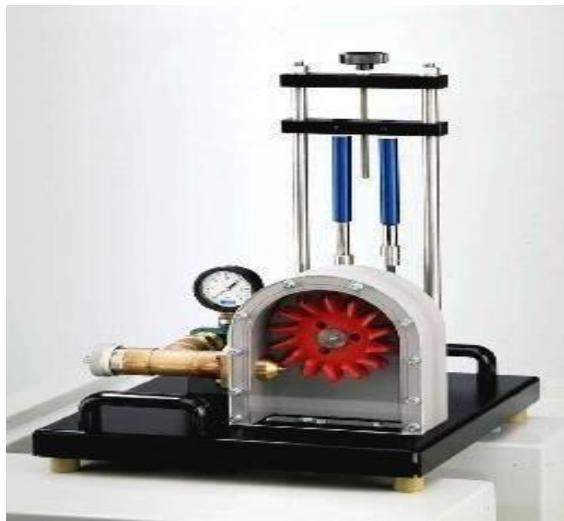
Figura 22. Principio de Funcionamiento de una Turbina de PELTON (Incluye Cuentarrevoluciones).
