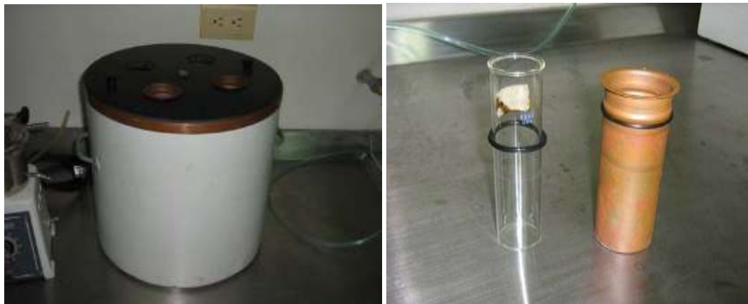
FIGURA 13. Equipo Laboratorio para la determinación del punto de fluidez
