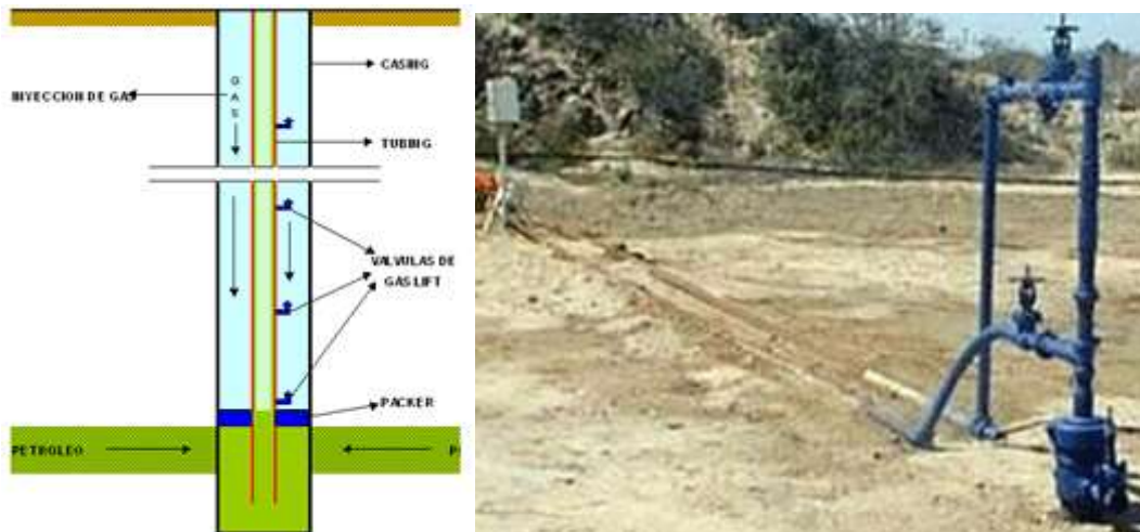
FIGURA 5. Equipo de Gas Lift
