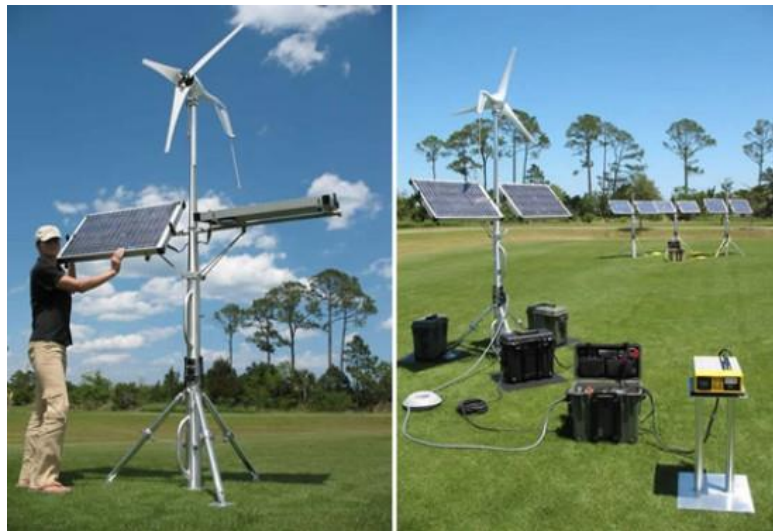
Figura 11. Sistema Híbrido Eólico – Fotovoltaico
