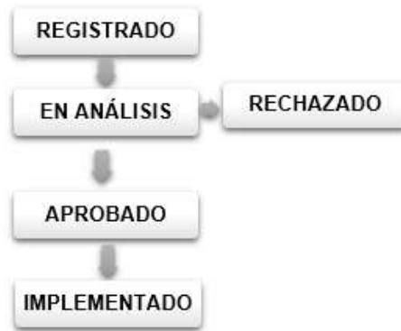
Ilustración 7: Diagrama de transición de estados para el ciclo de vida de las peticiones de cambio Fuente: (Lozada, 2017)
