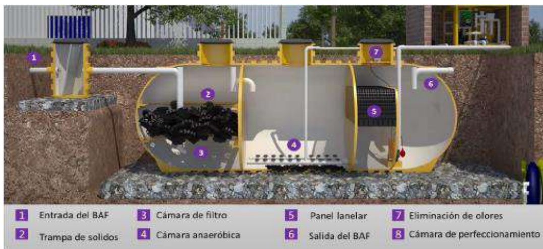
Imagen N° 87. Sistema de tanque séptico – BAF
