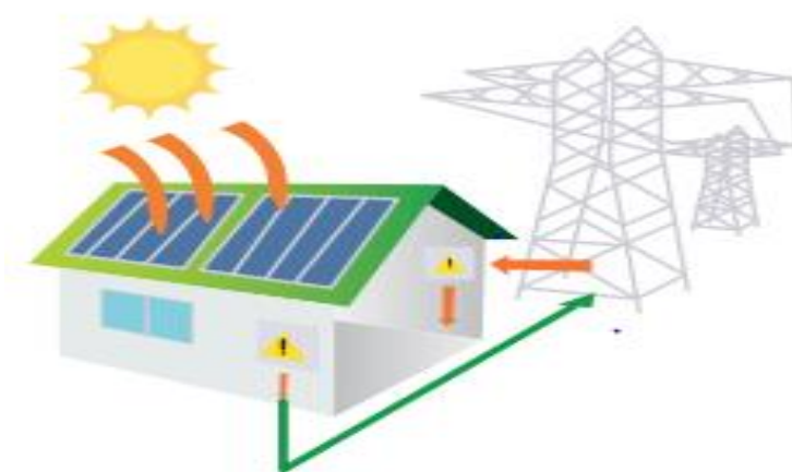
Figura 36. Sistema fotovoltaico conectado a red
