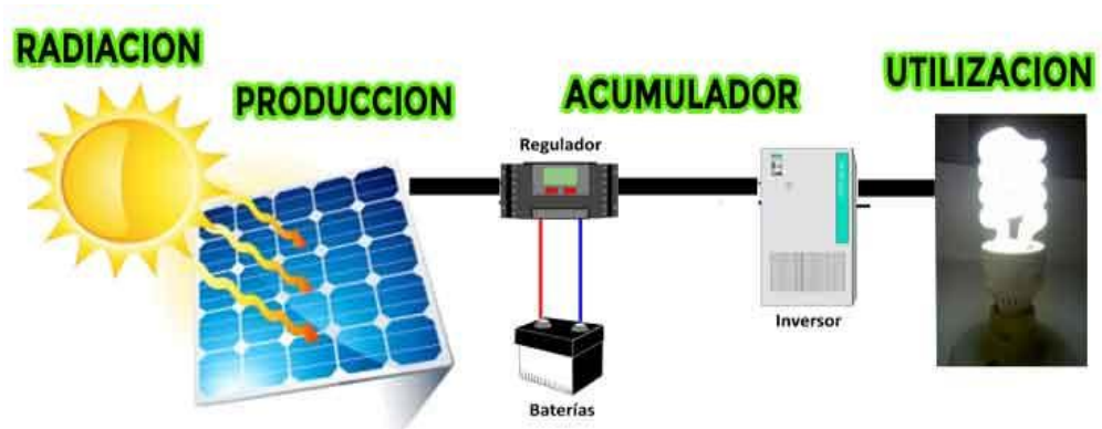
Figura 12: instalación solar fotovoltaica con inversor, utilización a 220Vca
