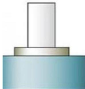
**2.2.8.2 PC (Physical Contact):** El ferrule viene con un pre pulido esférico convexo. Es utilizado en multimodo y monodo. La conexión más común es el conector de "Contacto Físico" (PC), en el cual las dos fibras se encuentran al igual como en el conector plano, pero las superficies son pulidas siendo levemente curvas o esféricas, la cual elimina el espacio de aire y fuerza a las fibras a entrar en contacto. La reflexión devuelta es de alrededor de -40dB. PC:>30dB.
