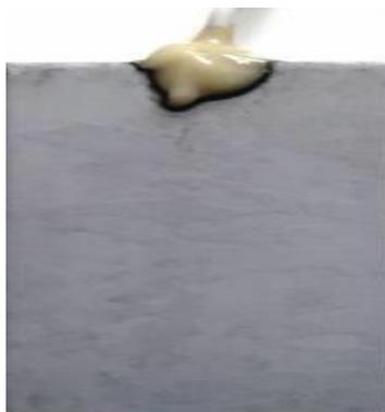
**Ilustración 6:** Muestra de acero ASTM A-36 protegida con corriente impresa, expuesta a bacterias en agua dulce, después de ser sometida a limpieza química.
