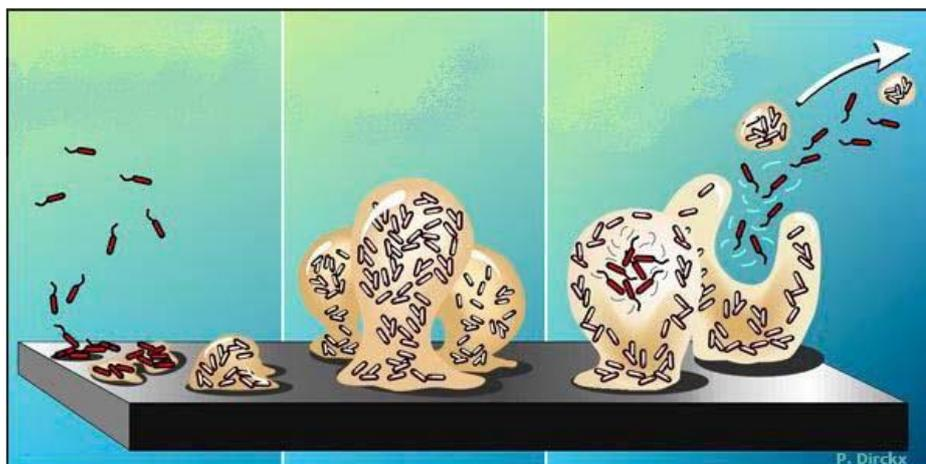
Ilustración 1. Ataque bacteriológico sobre una superficie metálica. Se forma una biopelícula o biofilm, generando un bulk bacteriano que en su interior genera las condiciones ideales para la biocorrosión.
