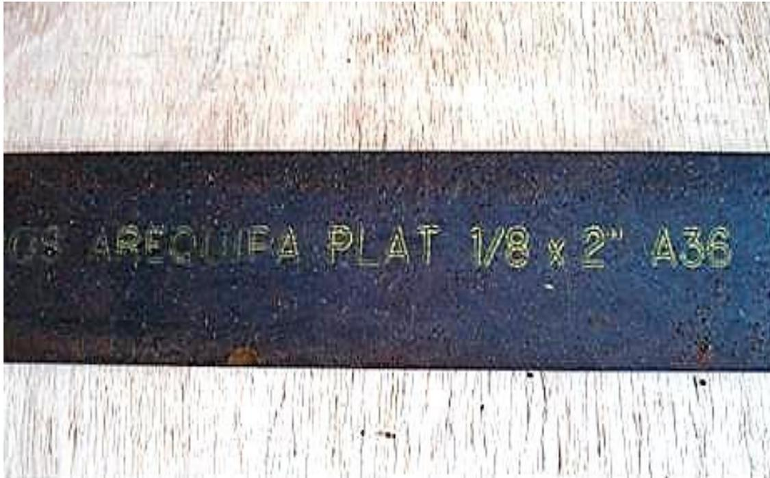
**Ilustración 15: Plancha de acero ASTM- A36**
