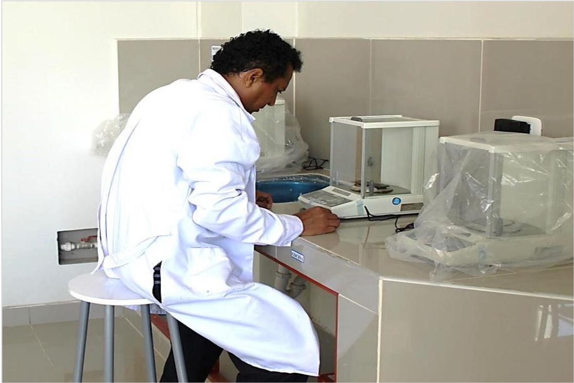
**Ilustración 30: Pesado de probetas previa limpieza con Norma ISO 8407**
