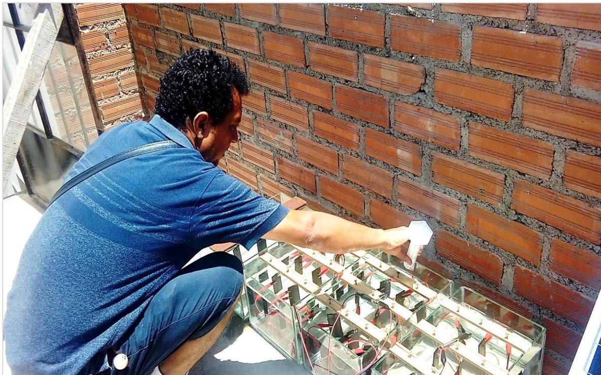
**Ilustración 25: Adición de bacterias al medio corrosivo para inicio de pruebas**
