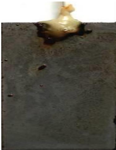
**Ilustración 5:** Muestra de acero ASTM A-36 expuesta en agua dulce y bacterias después de ser protegida con corriente impresa, aún sin limpiar los productos de corrosión.
