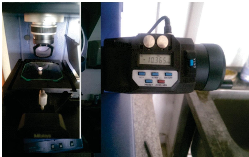
Fig 3. Análise da alteração dimensional (u) com os corpos de provas. Perfilômetro Mitutoyo.
