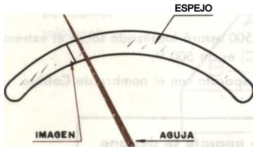
Fig. 8 INCORRECTO: Hay error de paralaje
