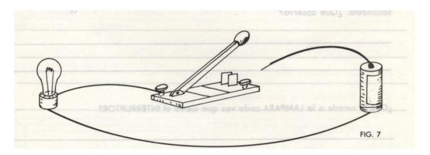
7. Conecte al borne sobrante del interruptor el extremo sobrante del cable que viene de la pila (Fig. 8).
