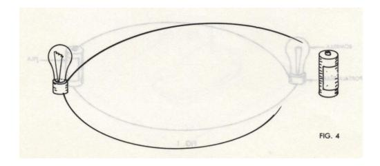
4. Pele los otros extremos del alambre y conecte uno a la parte de arriba de la pila y el otro a la parte de abajo de la pila. según la figura 5. Utilice para fijarlos cinta pegante de mascarilla o cinta aislante.
