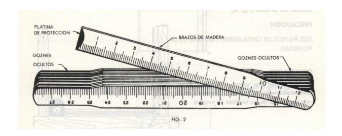
También hay metros en cintas enrollables llamados flexómetros (Fig. 3). El metro con brazos articulados provistos de resortes y goznes tiene la ventaja de que al abrirlo se mantiene rígido. Los metros de madera van provistos en ambos extremos de una platina que sirve de protección y
