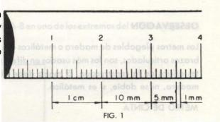
En una de sus caras tienen una graduación en centímetros y milímetros; en la otra cara tienen una graduación en pulgadas. (La pulgada equivale a 2,54 cms.).
