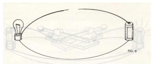
6. Conecte un extremo de cable libre al porta-lámpara y el otro a uno de los 2 bornes del **INTERRUPTOR** (Fig. 7)
