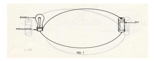
1. Pele un extremo de uno de los alambres y conéctelo a uno de los bornes del porta-lámpara según la figura 2.
