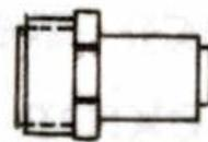
Esta es una pieza adicional, viene suelta en el empaque, y no forma parte integral de la válvula, se enrosca provisionalmente en el cuerpo de la válvula en reemplazo de la tuerca empaque o prensaestopa, mientras dura el proceso de enchape o acabado de la pared, donde quedará ubicada la ducha.
