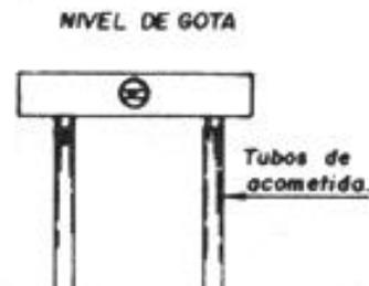
Coloque un nivel de gota o burbuja sobre el borde de los tubos de acometida y verifique su estado. Si es necesario, establezca la diferencia de altura entre los dos y recorte el exceso de longitud.
