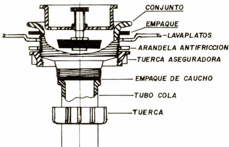
D. Coloque el empaque de caucho entre la base exterior de la canastilla y
