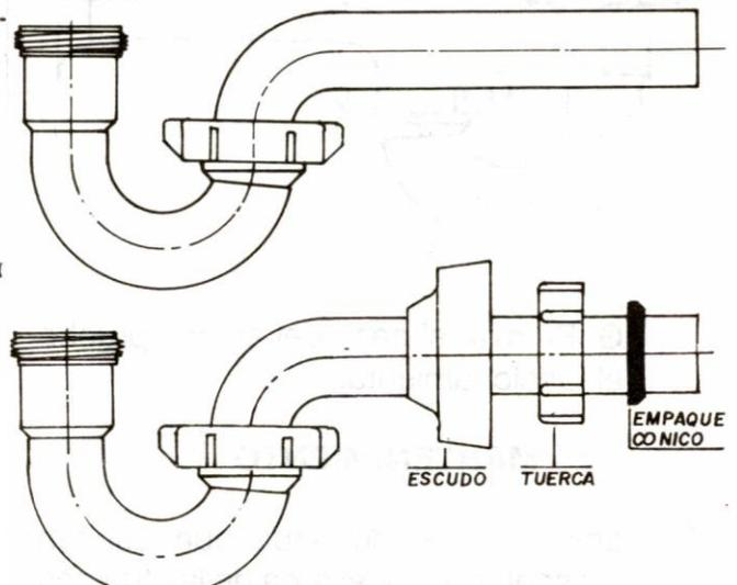
E. Por el extremo del tubo cola del sifón, inserte en su orden: el escudo, la tuerca del adaptador y el empaque cónico de caucho.
