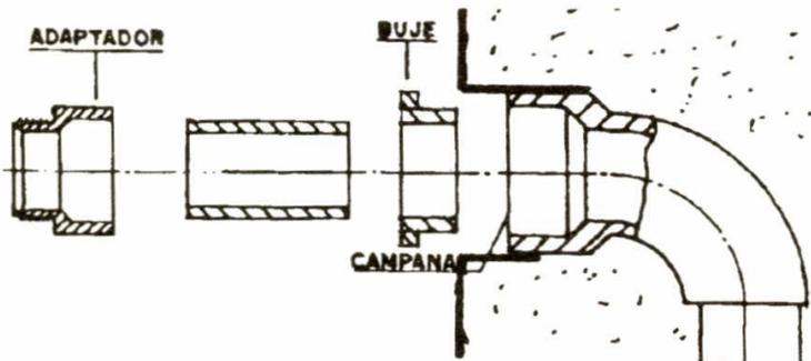
B. En el buje que acaba de instalar, suelde un adaptador de sifón PVC.
