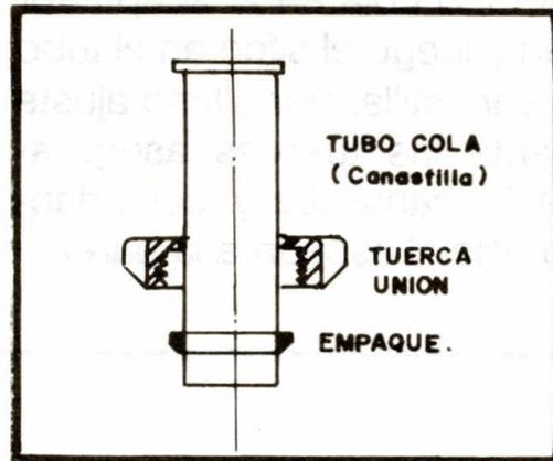
D. En la punta escalonada del tubo cola del sifón, coloque el empaque cónico de caucho, y arme el sifón.
