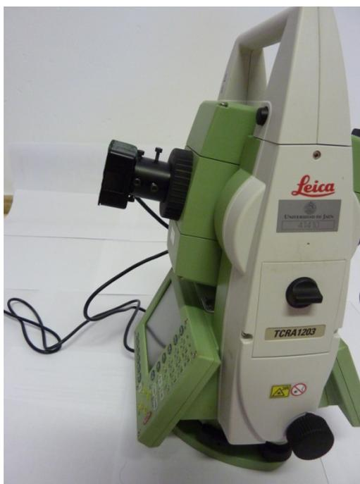
Figura 4.23. Cámara adosada al portaocular por medio del soporte-adaptador.
