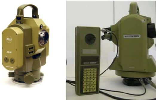
Figura 2.6. Video-teodolitos electrónicos E2-SE (Kern) Izquierda. TM3000V (Wild) Derecha.
