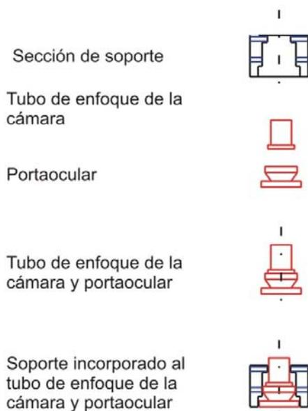
Figura 4.27. Esquema de inserción del adaptador de la cámara al portaocular.
