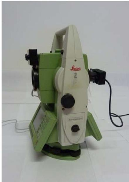
Figura 4.16. Sistema de medición, estación total y cámaras.
