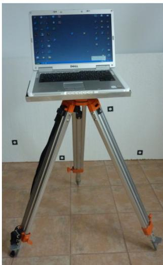
Figura 4.18. Soporte para ordenador portátil sobre trípode.
