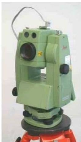
Figura 2.11. Prototipo de integración de cámaras con estación total (Scherer – Juretzko)
