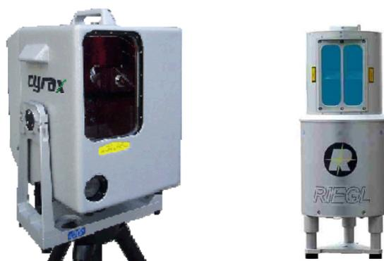
Figura 2.14. Escáner CyraX 2500 (Izquierda). Riegl MLS Z210 (Derecha).
