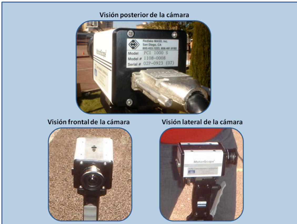
Figura 3.4.- Cámara de video digital de alta velocidad, Redlake Motion Scope PCI 1000S empleada en el estudio.
