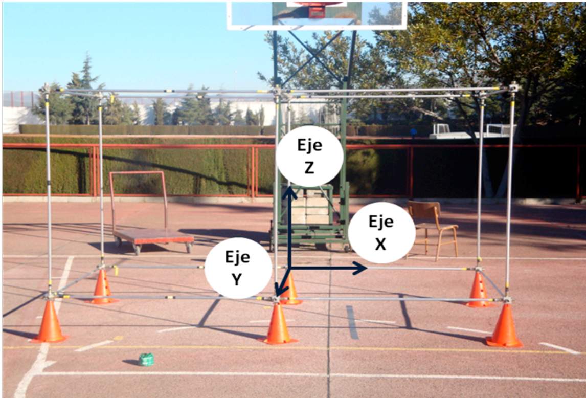
Figura 3.8- Representación del objeto de referencia utilizado para la reconstrucción tridimensional del movimiento.
