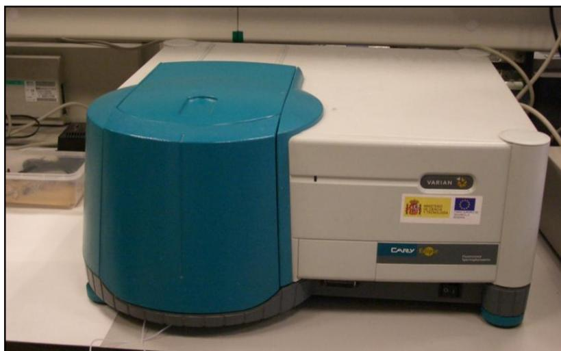
**Figura V.5.** Fotografía del espectrofluorímetro "Varian Eclipse".
