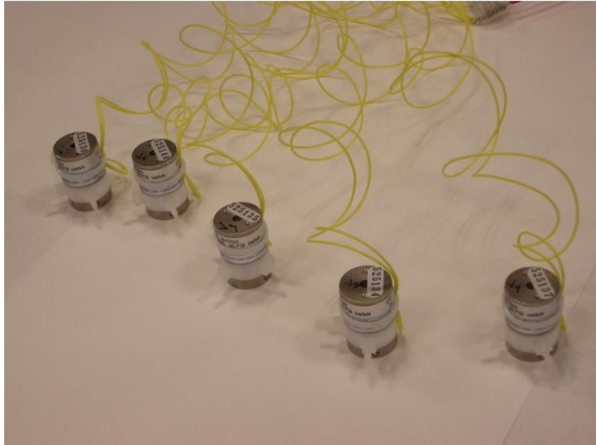
**Figura V.2.** Fotografía de válvulas solenoide de tres vías.
