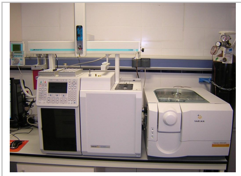
Figura III.6. Equipo de cromatografía de gases/espectrometría de masas con analizador de triple cuadrupolo (GC-300MS Varian) utilizado en los experimentos.
