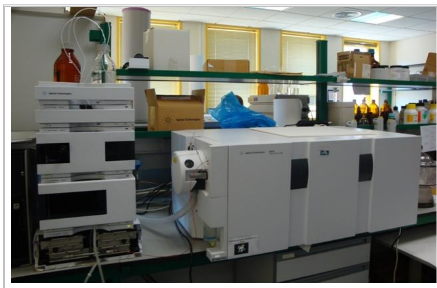
Figura III.5. Equipo de cromatografía de líquidos/espectrometría de masas con analizador de triple cuádrupolo (LC-QQQMS Agilent 6410 Triple Quad) utilizado en los experimentos. Grupo de investigación Residuos de plaguicidas (AGR-0159). Universidad de Almería.
