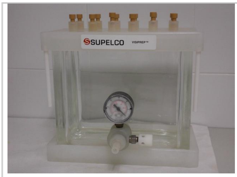
Figura III.1. Dispositivo de vacío utilizado para la extracción en fase sólida (Supelco Visiprep®).
