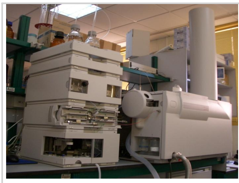
Figura III.4. Equipo de cromatografía de líquidos/espectrometría de masas con analizador de tiempo de vuelo (LC-TOFMS Agilent MSD TOF) utilizado en los experimentos. Grupo de investigación Residuos de plaguicidas (AGR-0159). Universidad de Almería.
