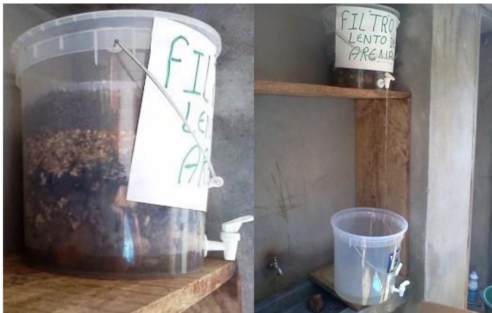
Figuras 21 y 22. Filtro terminado y en funcionamiento.
