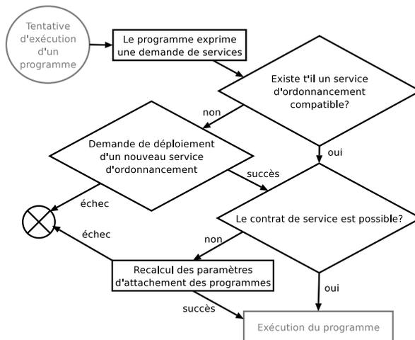
Figure 4 – Algorithme de déploiement d'un ordonnanceur
