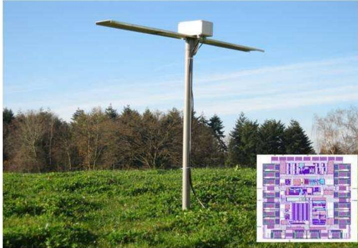
Figure 45- Antenne dipolaire active CODALEMA développée au laboratoire SUBATECH
