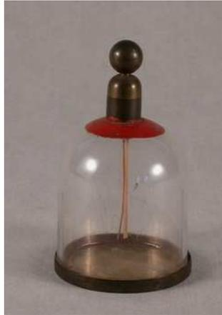
Figure 1- Electroscope à feuilles d'or
