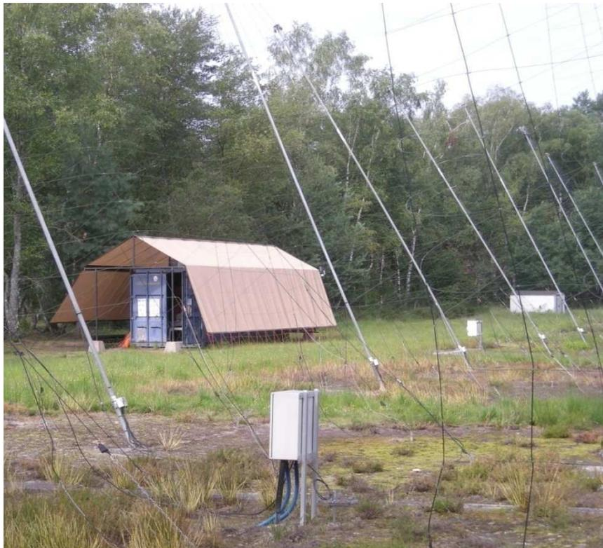
**Figure 61-Casemate d'acquisition de l'expérience CODALEMA. La toile, installée en 2007, réduit la chaleur à l'intérieur du container l'été et permet à l'expérience de fonctionner sans interruption**
