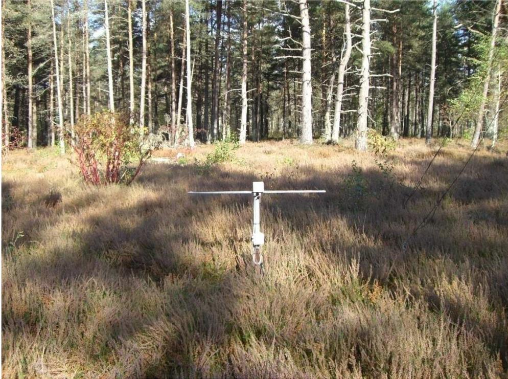
**Figure 60- Antenne dipolaire E01 dans l'actuelle configuration de CODALEMA**
