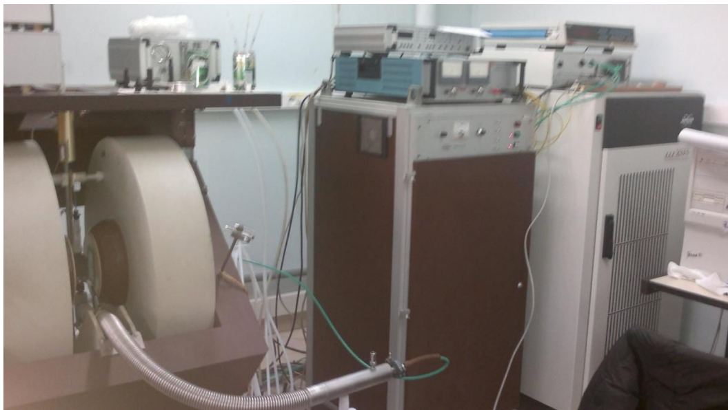
Figure II. 17. Dispositif expérimental d'un spectromètre à résonance paramagnétique électronique.
