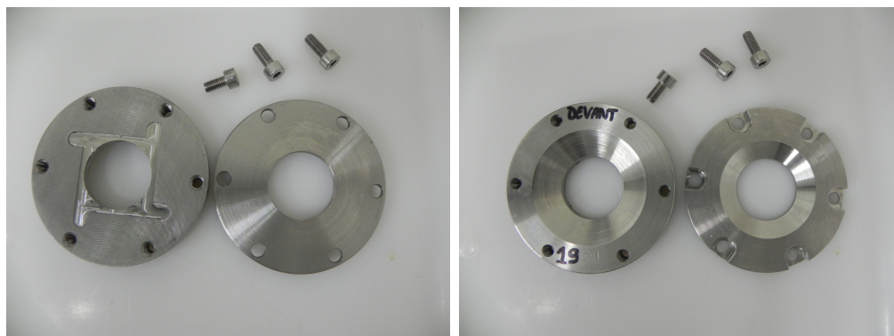
FIGURE 2.7 – Vue intérieure (à gauche) et extérieure (à droite) de la capsule utilisée pour l'irradiation du stack.
