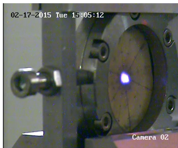
FIGURE 2.10 – Cible en oxyde d'aluminium placée sur le dispositif Nice-III, en cours d'irradiation pour le réglage du faisceau.
