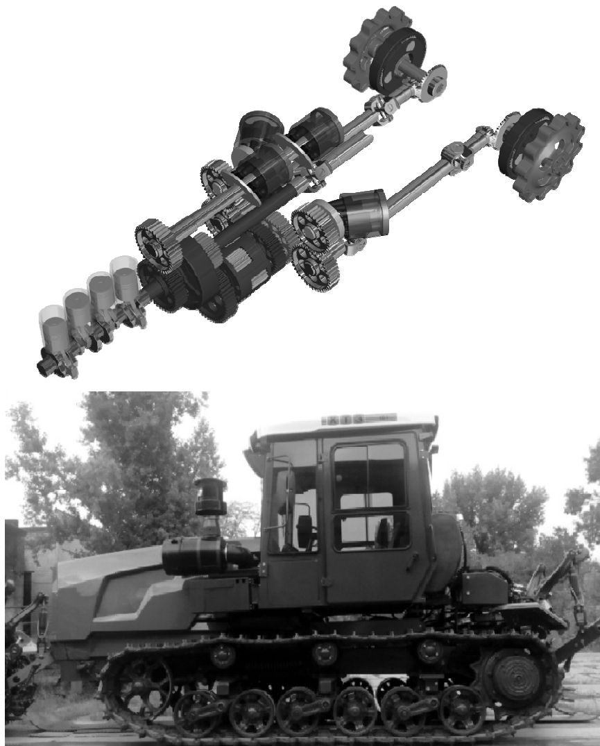
Рис. 6– 3D эскиз ГОМТ-200 с автономным бесступенчатым управлением скорости и тягового усилия в прямолинейном движении и радиуса в повороте для гусеничного трактора ХТЗ-243
