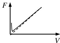
Рис. 1. Зависимость частоты импульсов от скорости потока
