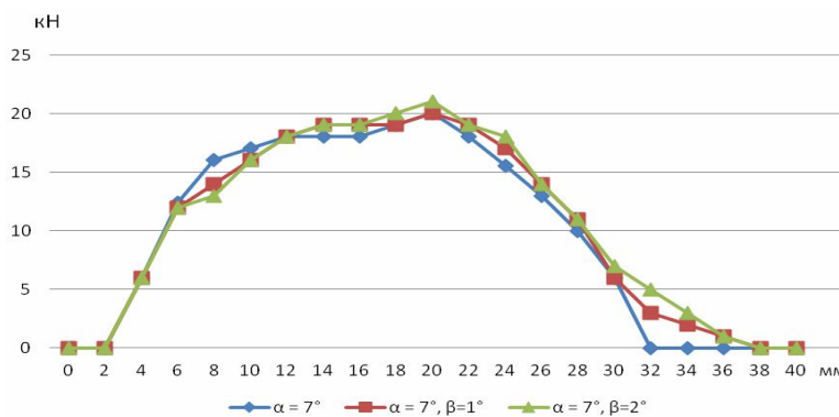
Рис.5. График зависимости усилие – перемещение при вытяжке с утонением для пары алюминий АмцМ – титан ВТ1, через матрицы с переменной конусностью матрицы и с постоянной. ( f_{тр.} = 0,01 )
