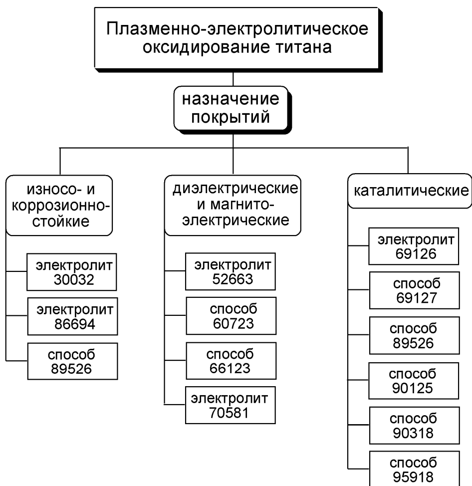
Рисунок 5.3. Обобщенная схема синтеза функциональных оксидных покрытий на сплавах титана
