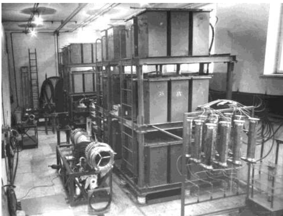
ГИТ с запасаемой энергией 320 кДж для исследования и создания лазерного излучения на основе углекислого газа
