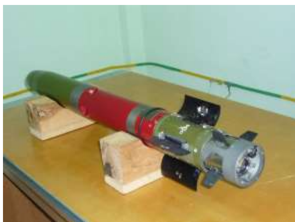
Испытания в НИПКИ «Молния» противотанкового управляемого ракетного снаряда на соответствие требованиям электромагнитной совместимости
