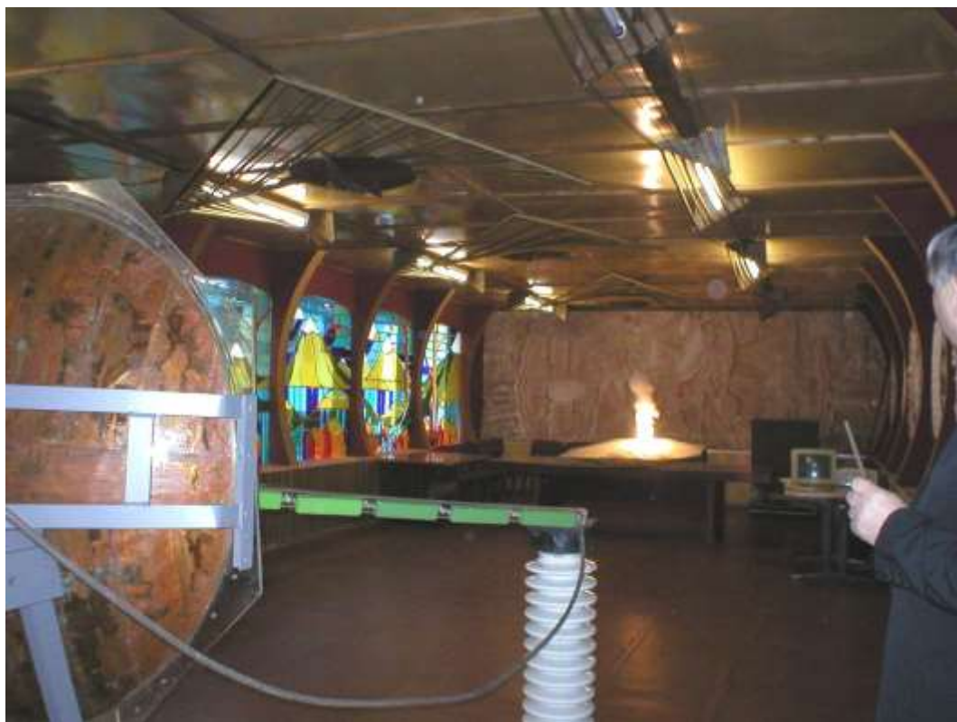
Демонстрация дистанционного подрыва заглубленных минно-взрывных устройств электромагнитным воздействием
