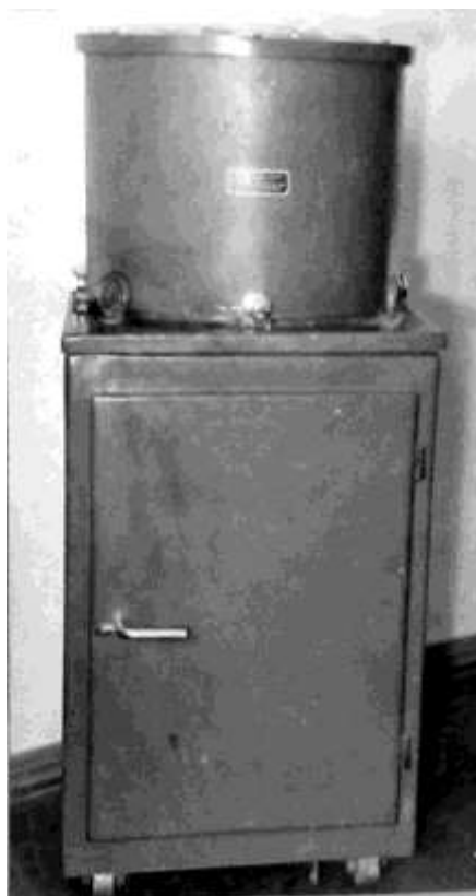
Стартерный механический выпрямитель для запуска корабельных газовых турбин с рабочим напряжением 36 В и максимальным током 3 кА (разработка группы лаборатории под руководством И. В. Белого)
