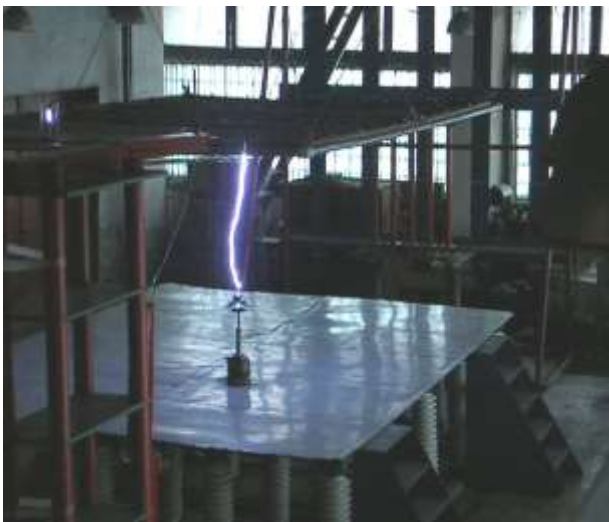
Исследование параметров процесса пробоя длинных воздушных промежутков на высоковольтном стенде ВВС-1.2
