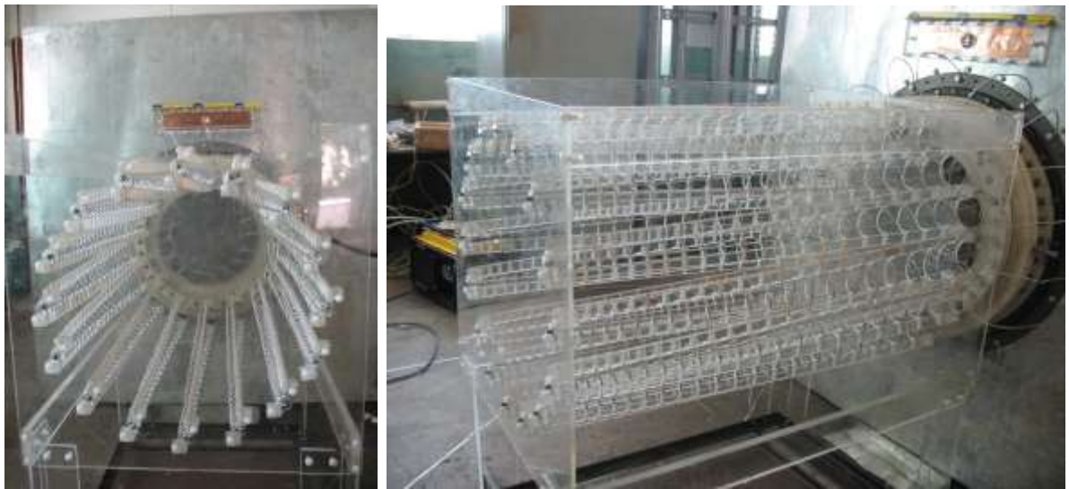
Шестнадцатиантенный излучатель в составе мощной излучающей установки
