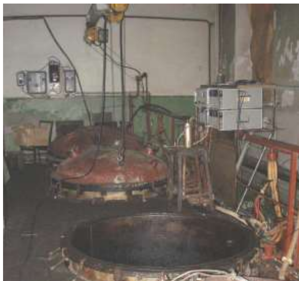
Производственный участок сушки и пропитки конденсаторов
