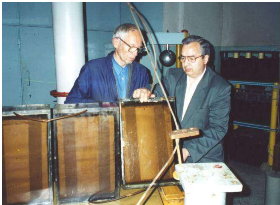
Зав. отделом №6, д-р техн. наук М. И. Баранов (справа) и науч. сотр. Ю. П. Зябко (слева) за наладкой высоковольтной испытательной схемы на территории комплекса с генератором ГИН-1,2
