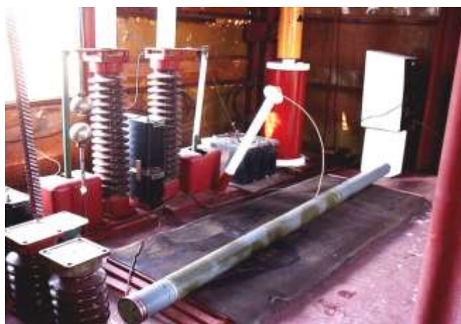
Испытания в НИПКИ «Молния» ракетной системы залпового огня «Град» на воздействие разрядов статического электричества
