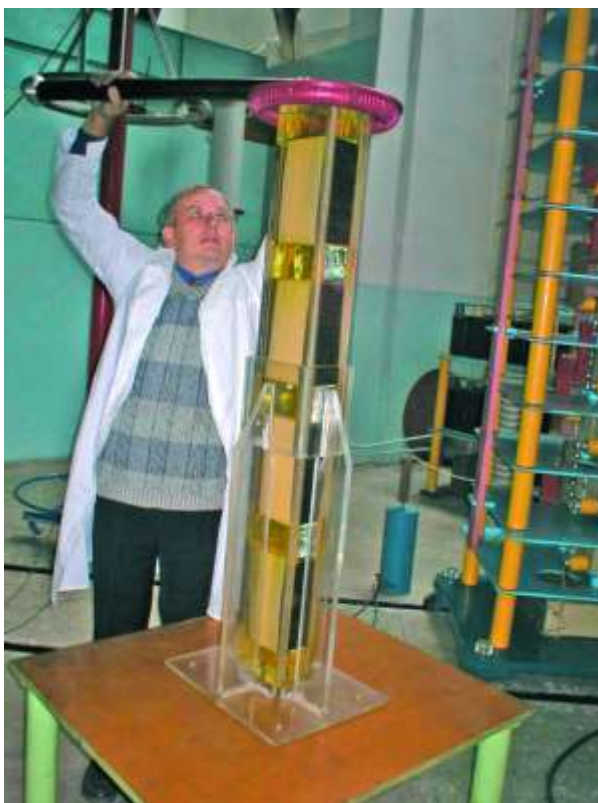
Сборка высоковольтного импульсного конденсатора на напряжение 600 кВ емкостью 1пФ (руководитель отдела проф. В. В. Рудаков)
