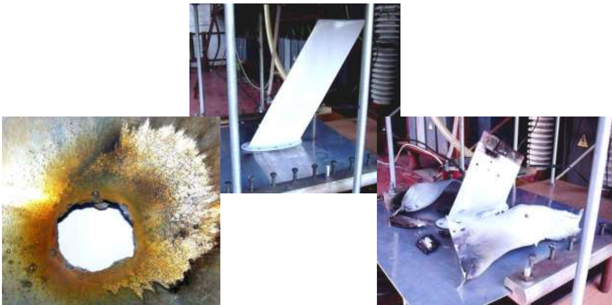
Разрушение прямым ударом импульсного тока искусственной молнии с нормированными амплитудно-временными параметрами, формируемого в разрядной цепи ГТМ, опытных образцов алюминиевой обшивки и приемно-передающей антенны летательного аппарата
