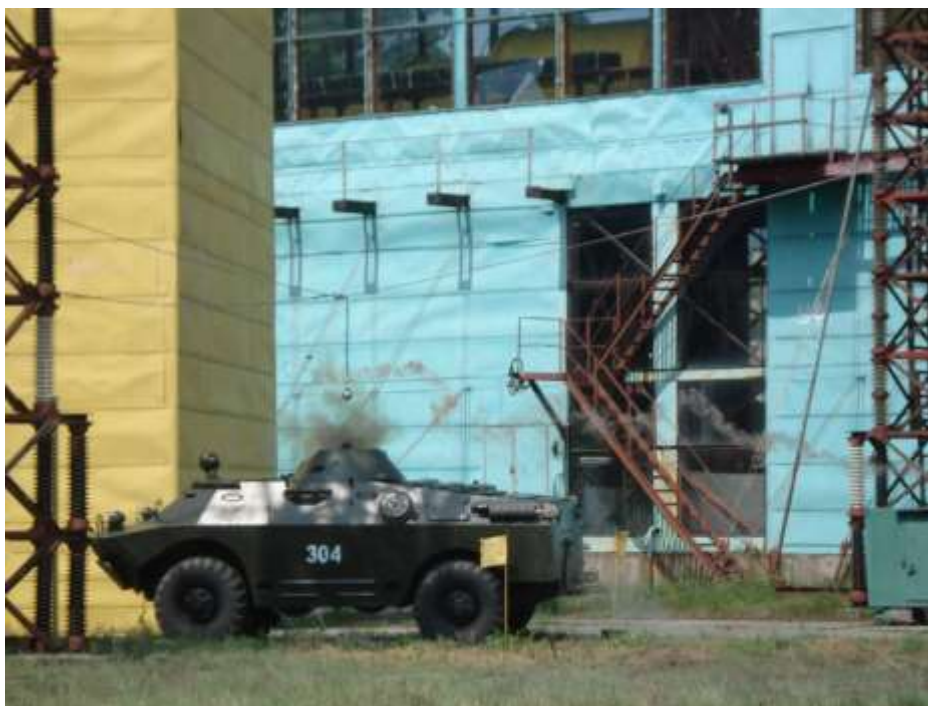
Испытание в НИПКИ «Молния» боевой разведывательно-дозорной машины на воздействие имитированного грозового разряда
