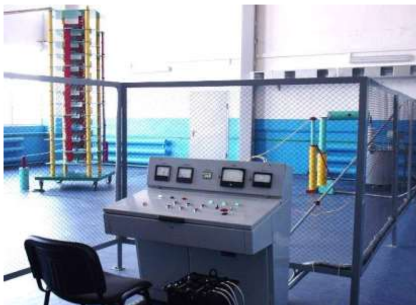
Общий вид действующего высоковольтного испытательного комплекса на базе генератора ГИН-1,2, разработки НИПКИ «Молния» (НПО «Полимер», г. Артемовск Донецкой обл.)
