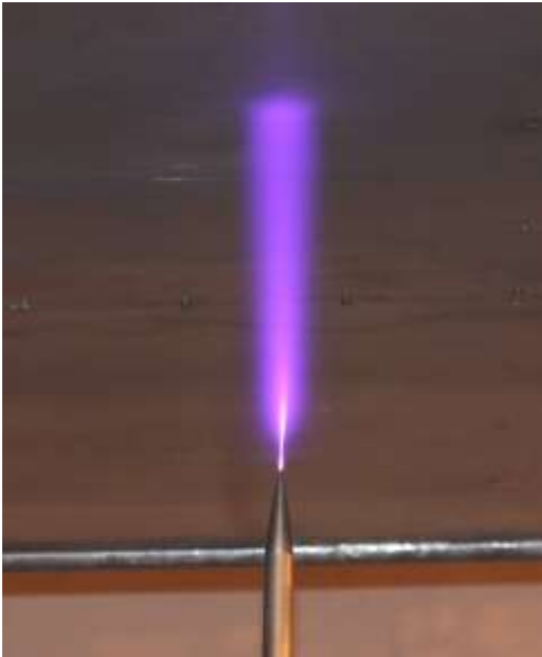
Исследование импульсной короны со стержневых молниеприемников для воздушного промежутка 0,4 м
