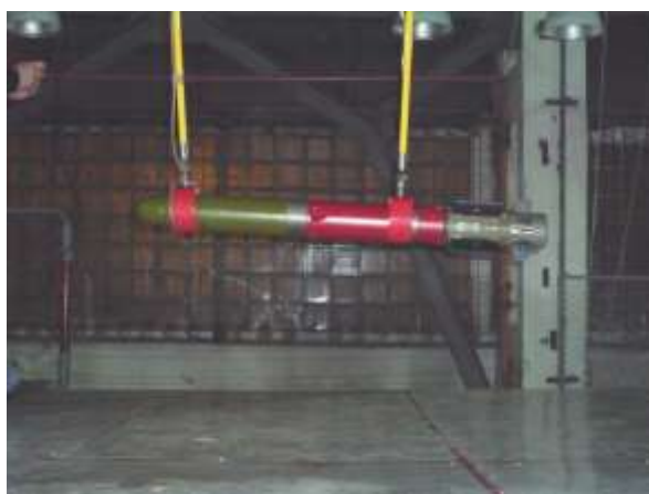
Испытания в НИПКИ «Молния» противотанкового управляемого ракетного снаряда на соответствие требованиям электромагнитной совместимости
