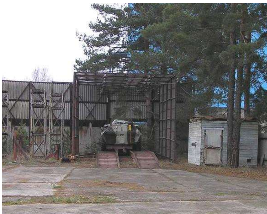
Испытание в НИПКИ «Молния» боевой разведывательно-дозорной машины на воздействие электромагнитных полей высоковольтных ЛЭП
