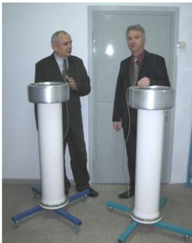
Опытные образцы испытательных конденсаторов переменного напряжения 110 кВ емкостью 8 нФ демонстрируют В. В. Рудаков (слева) и С. В. Емельянов (справа)
