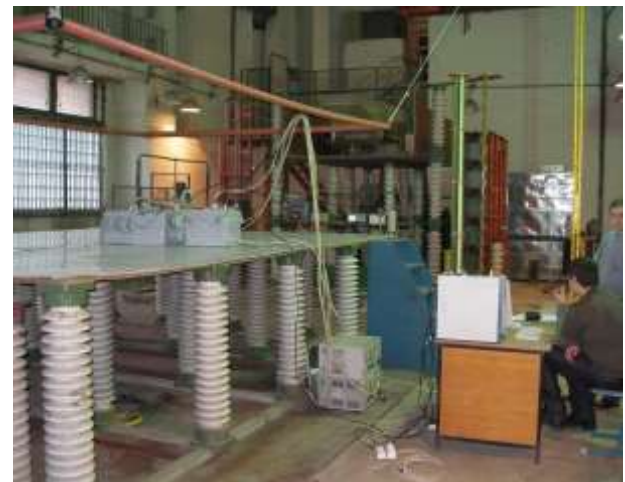
Испытание устойчивости бортовой аппаратуры системы управления ракеты носителя «Циклон 4» к действию импульсных электромагнитных полей
