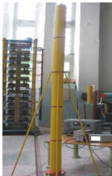
Делители напряжения разработки НИПКИ «Молния» на 100 кВ (слева) и на 1 МВ (справа)
