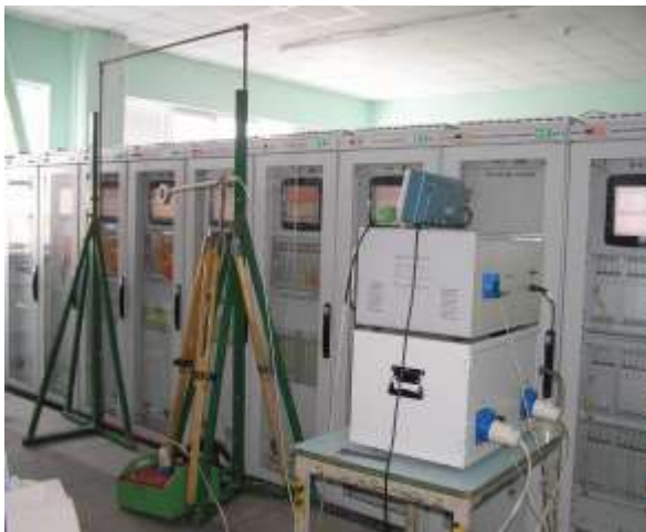
Испытание устойчивости шкафа формирования сигналов программно-технического комплекса системы безопасности управления АЭС к действию магнитного поля частоты сети
