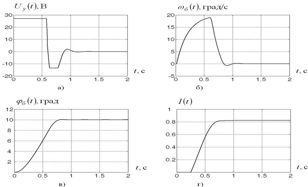
Рисунок 3 – Переходные процессы замкнутой системы с переменной структурой (законом управления) для оптимальных параметров регулятора: по напряжению управления  $U_y(t)$  (а), угловой скорости  $\omega_о(t)$  (б), угла поворота  $\varphi_о(t)$  (в), целевой функции  $I(t)$  (г)
