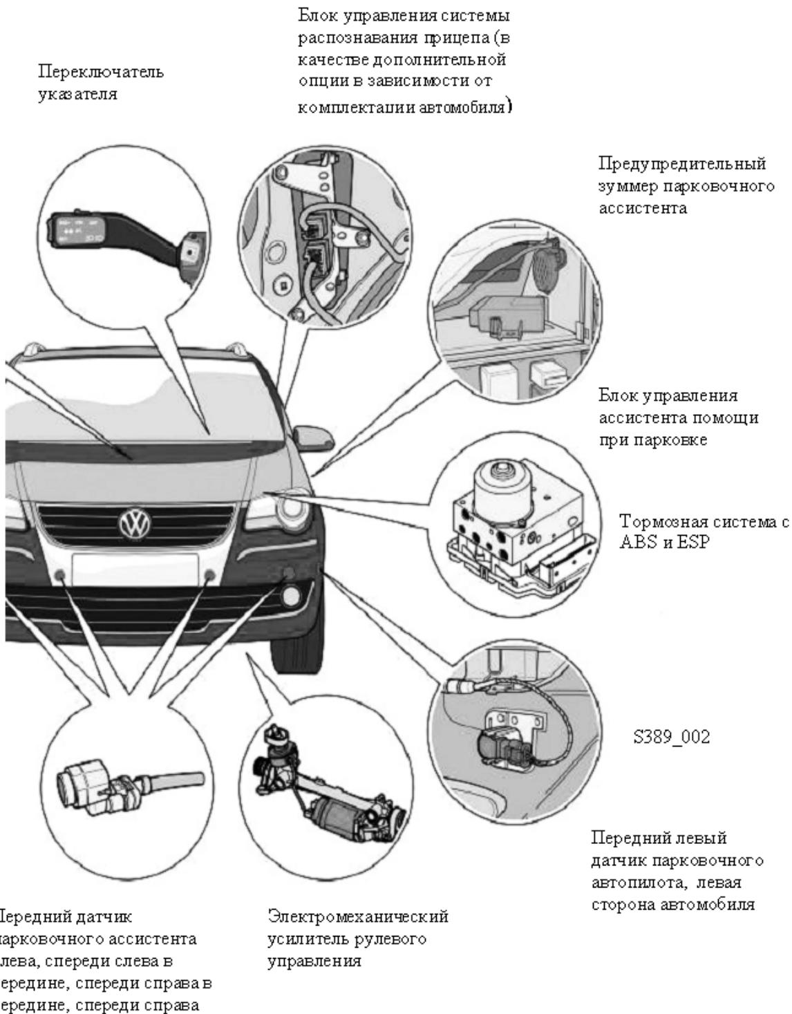
Рисунок 1 – Схема расположения элементов парковочного автопилота
