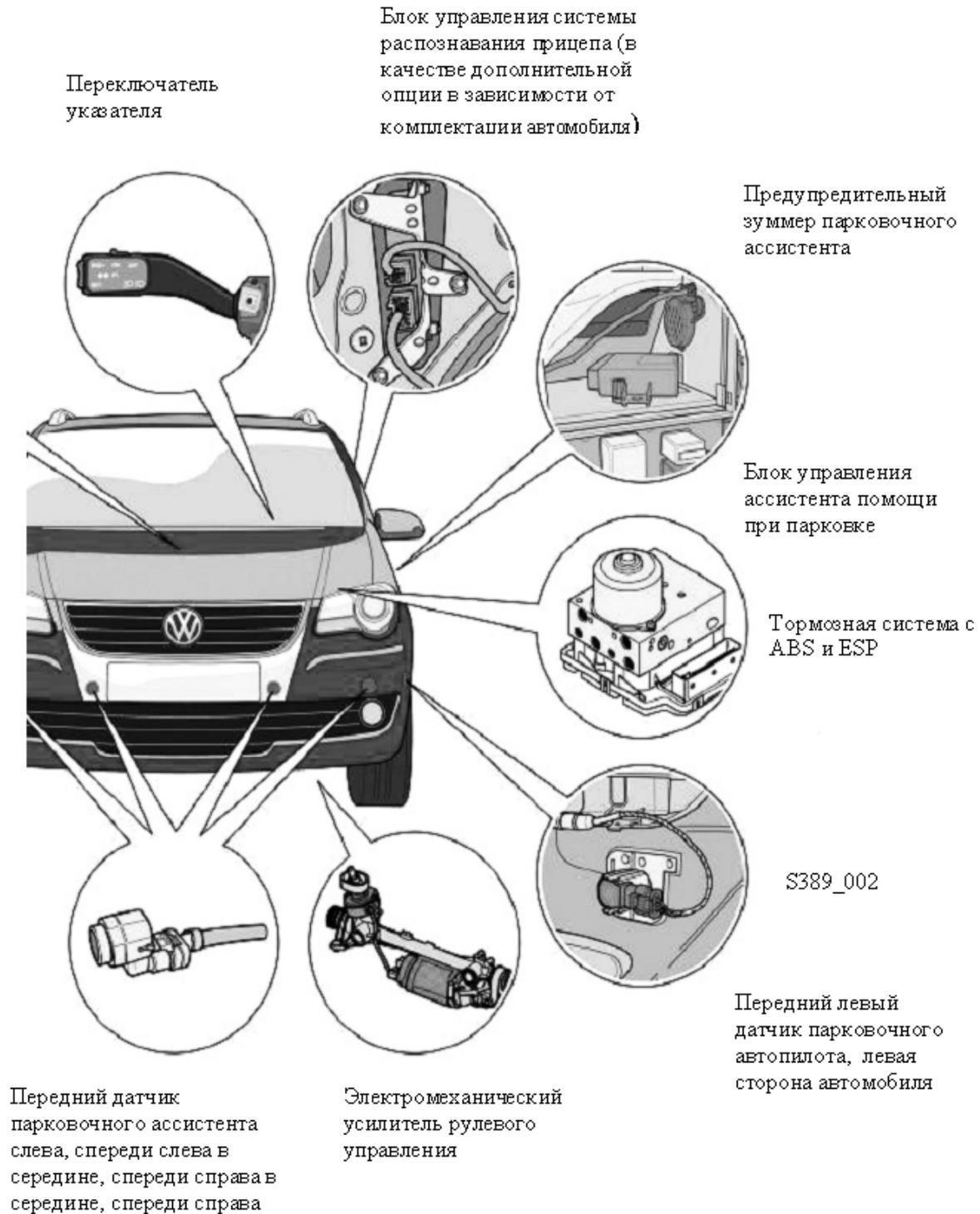
Рисунок 1 – Схема расположения элементов парковочного автопилота
