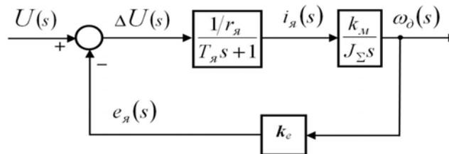
Рисунок 2 – Структурная схема электродвигателя независимого возбуждения
