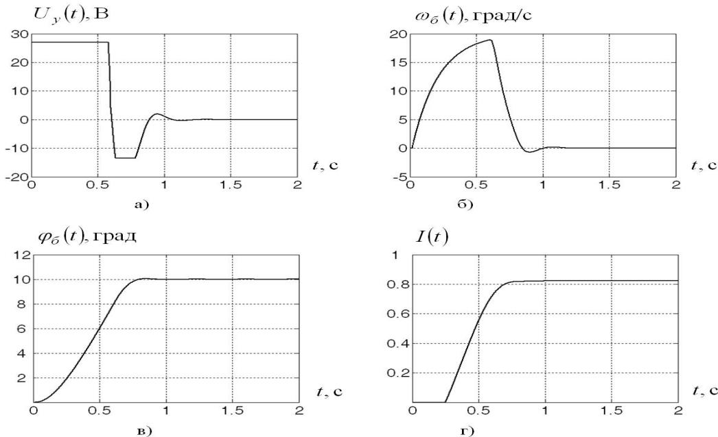
Рисунок 3 – Переходные процессы замкнутой системы с переменной структурой (законом управления) для оптимальных параметров регулятора: по напряжению управления  $U_y(t)$  (а), угловой скорости  $\omega_{\delta}(t)$  (б), угла поворота  $\varphi_{\delta}(t)$  (в), целевой функции  $I(t)$  (г)
