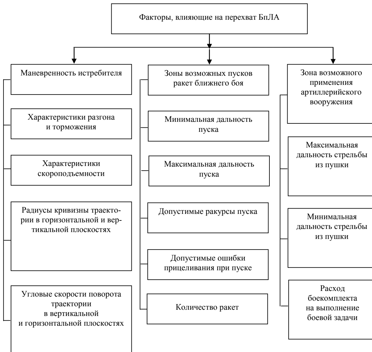
Рисунок 2 – Факторы, влияющие на выполнение задачи перехвата БПЛА
