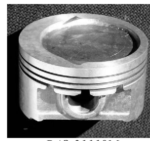
ВА3-21118M Ø82,5мм. Масса 235 г. (поршень не испытан в двигателе)
