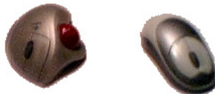
Figure 5 : Dispositifs de pointage (trackball et souris)
