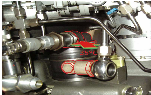
FIG. 6: Vue augmentée de l'opérateur après un "Outlining". L'expert a sélectionné les éléments d'intérêt et indiqué la température d'un objet.
