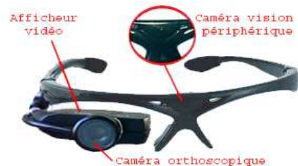
FIG. 3: Prototypé de nos lunettes de RA nommée MOVST.
