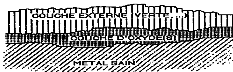
Fig. II.1 : modèle général de la stratification des produits de corrosion de bronzes anciens (en absence de chlorure cuivreux).
