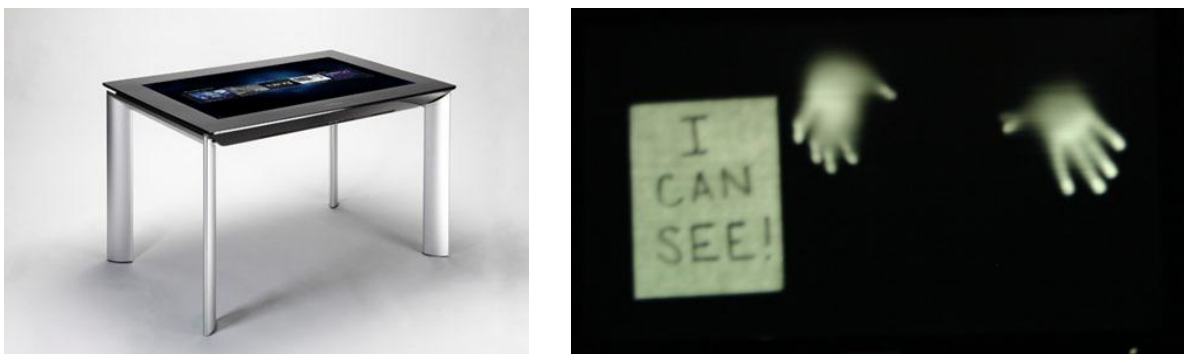
Figure 31 - A gauche, la table interactive SUR40 ou Microsoft Surface V2 . A droite, ce que voient les capteurs en niveaux de gris. Sources : http://www.betanews.com et http://blogs.msdn.com
