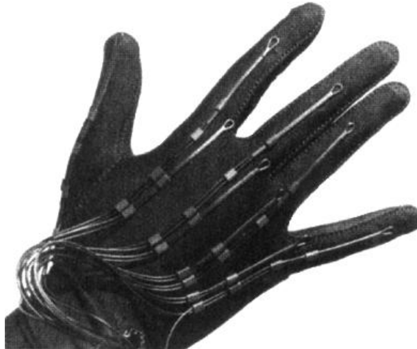
Figure 2 - Le gant de données à fibres optiques conçu par Thomas Zimmerman en 1987, VPL Research.
