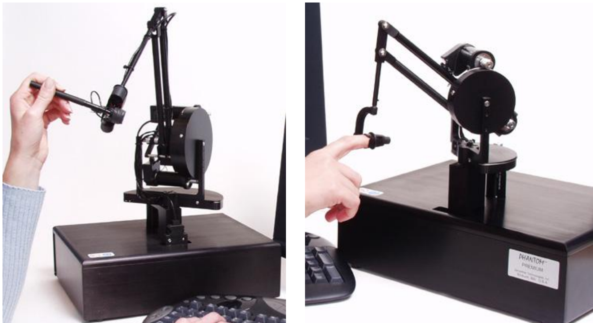
Figure 3 - Bras haptique « Phantom » de la société SensAble.
