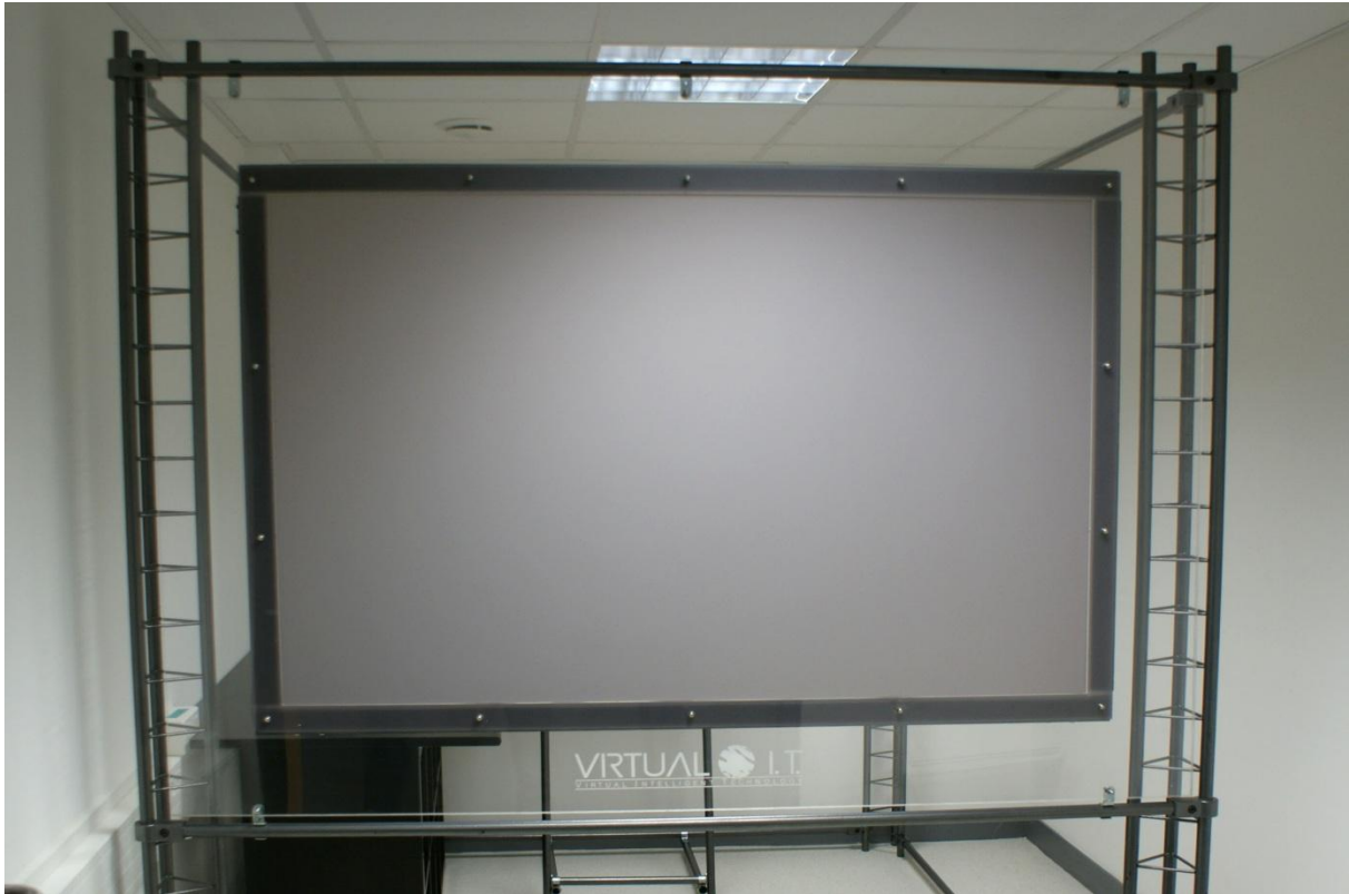
Figure 62 - Vue avant du prototype T1 multi-tactile. L'écran a une largeur de 2m et une hauteur de 1,5m. Aujourd'hui, ce prototype est installé à l'école Epitech Toulouse dans le cadre du partenariat entre l'école et l'entreprise.
