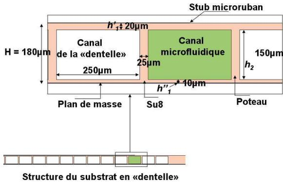
Figure 2. Coupe transversale du substrat évidé
