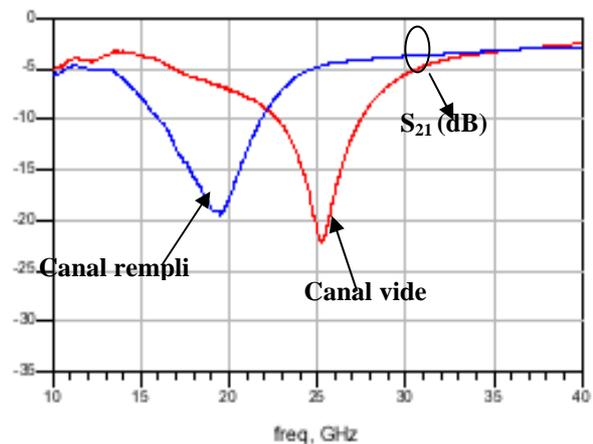
**Figure 6. Résultats de mesure du Stub quart d'onde**
