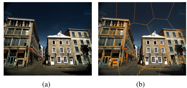
FIGURE 4 – (a) Image originale (2448 × 2050). (b) Image segmentée en utilisant les superpixels [1] avec les paramètres K = 20 , c = 20 , cf. § 2.1 pour plus de détails.
