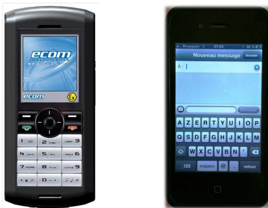
Figure 9. Exemple de clavier alphanumérique (à gauche) et de clavier azerty (à droite)
