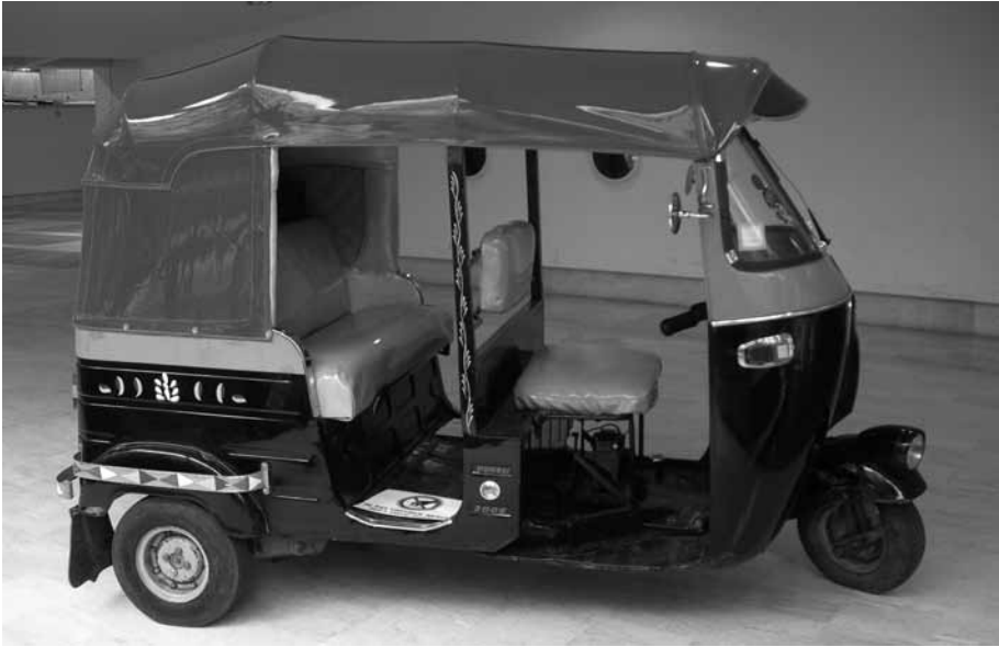
Fig. 1 - Autorickshaw Bajaj RE 25. Moteur à deux temps de 145,45 cm 3 , refroidissement à air. Châssis monocoque en tôle d'acier emboutie (2625 x 1300 x 1710 mm), 277 kg à vide. « Lucky » est un modèle fabriqué en 1983, moteur et châssis d'origine. Rénovation complète (cl. F. Wateau).
