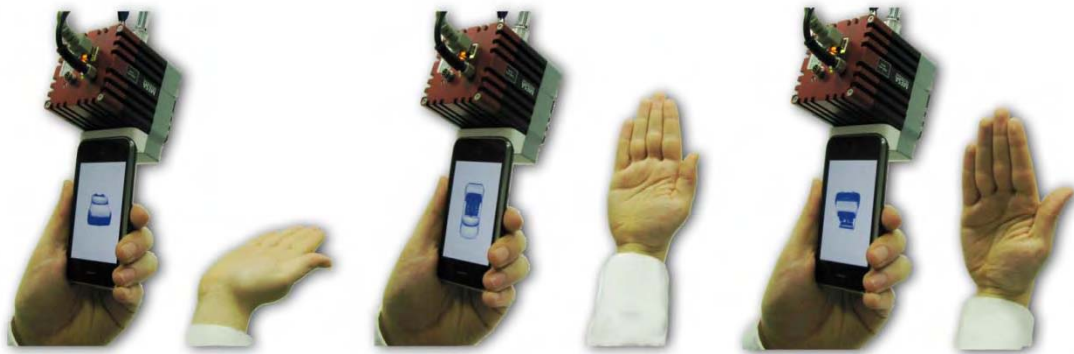
Figure 56 : La technique « PalmSpace » proposant des mouvements continus de rotation de la main à proximité du smartphone pour orienter un objet 3D (Kratz et al. 2012)
