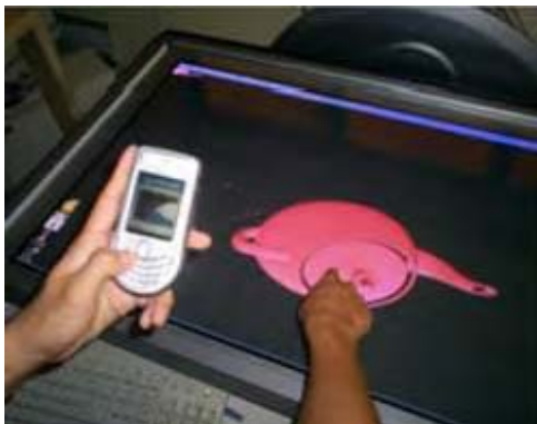
Figure 60 : Illustration d'une interaction autour du smartphone pour manipuler un objet 3D distant (Jeon et al. 2009)
