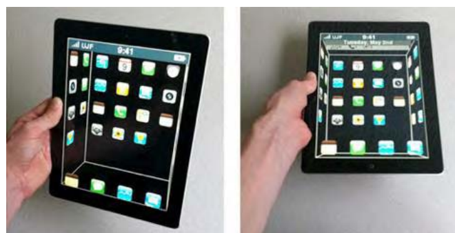
Figure 47 : Illustration de l'utilisation du suivi de mouvement de la tête de l'utilisateur pour changer le point de vue dans un EV3D (Francone and Nigay 2011)
