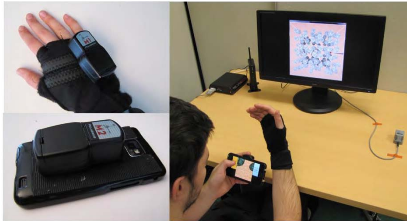
Figure 90 : Marqueurs du Polhemus Patriot Wireless fixé sur la main de l'utilisateur et derrière le smartphone (à gauche). Un exemple d'utilisateur en cours d'interaction avec la technique Mid-Air Hand (à droite)
