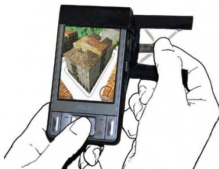
Figure 46 : Contrôle de la navigation avec un objet physique élastique à côté du smartphone (Hachet, Poudroux, and Guitton 2008)
