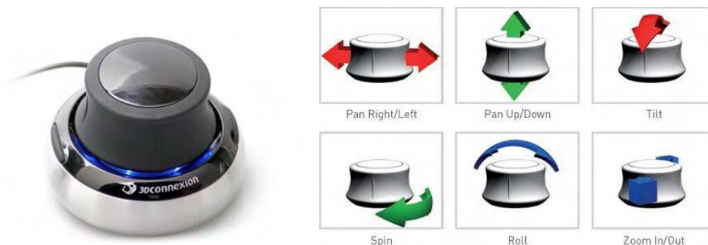
Figure 73 : La souris 3D Space Navigator ("3Dconnexion : SpaceNavigator" 2015) utilisée et les actions physiques possibles
