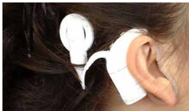
Figure 3. Partie externe de l'implant cochléaire.
